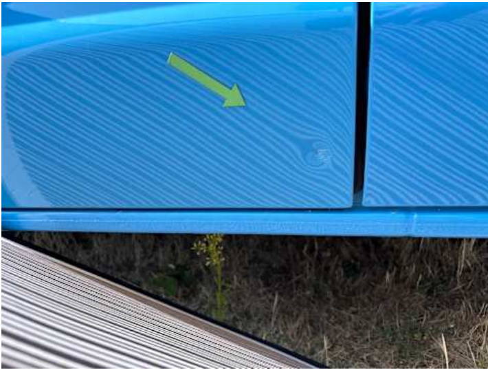
Türe hinten rechts (Kratzer, Lackschaden, Delle)
