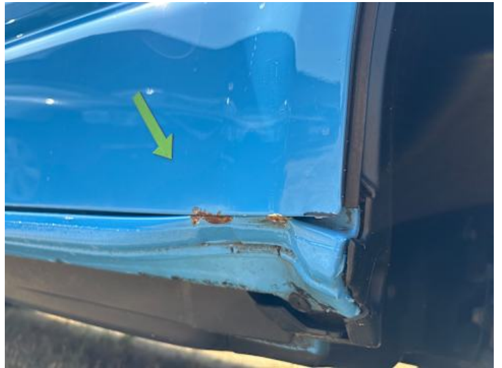
Schweller rechts (Delle, Lackschaden, Rost)
