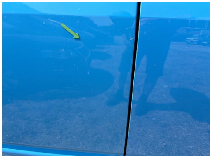
Türe hinten rechts (Kratzer, Lackschaden)
