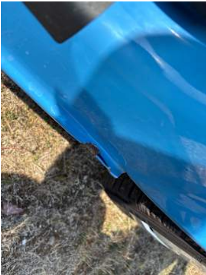
Schweller rechts (Delle, Lackschaden, Rost)
