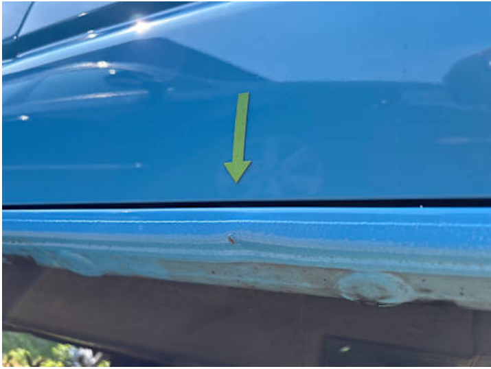
Schweller rechts (Delle, Kratzer)
