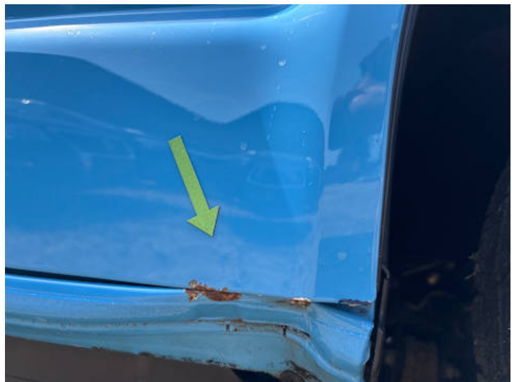
Beifahrertür (Lackschaden, Rost)
