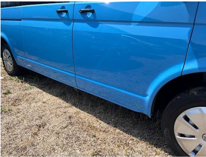
Schweller rechts (Delle, Lackschaden, Rost)
