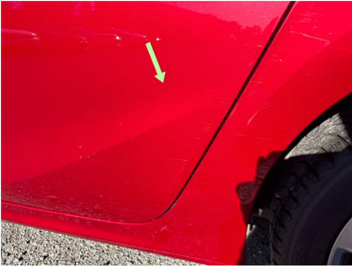
Türe hinten links (Kratzer, Verformung)
