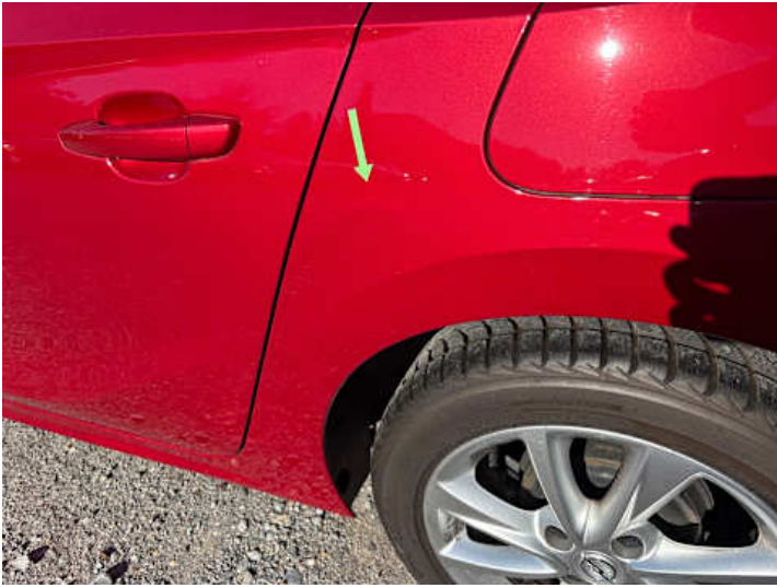
Seitenteil hinten links (Verformung, Lackschaden)
