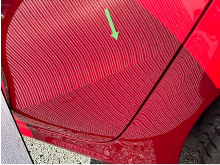
Türe hinten links (Kratzer, Verformung)
