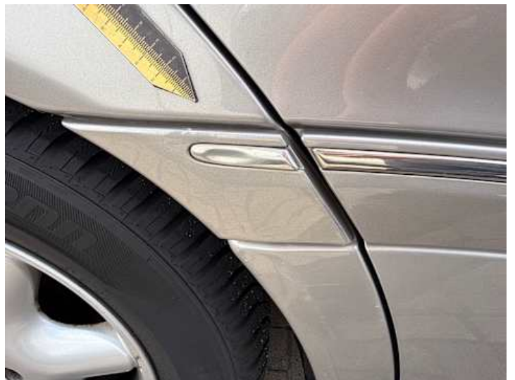
Seitenteil hinten rechts (Kratzer, Riss/Bruch)
