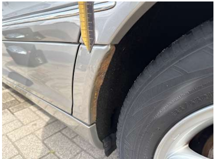
Seitenteil hinten links (Rost)
