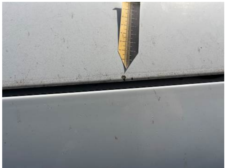
Motorhaube (Steinschlag, Ausgeblichen/Matt)
