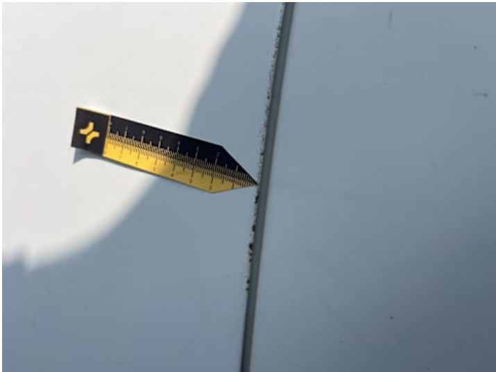
Fahrertür (Lackschaden, Rost)
