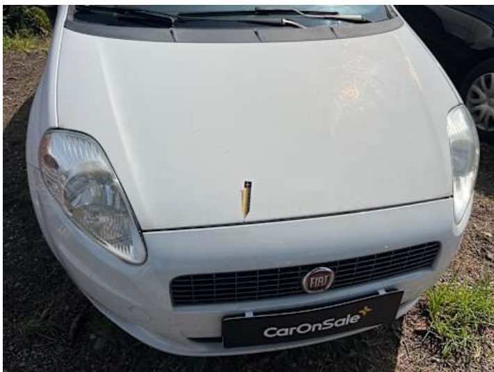
Motorhaube (Steinschlag, Ausgeblichen/Matt)
