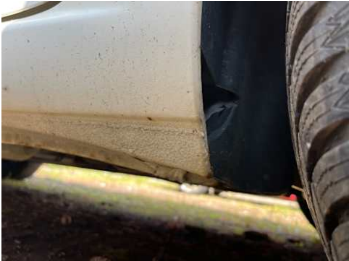
Schweller links (Rost, Lackschaden)
