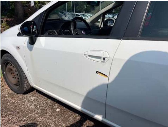
Fahrertür (Lackschaden, Rost)
