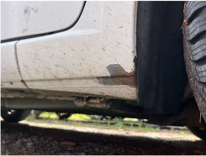
Schweller rechts (Rost, Lackschaden)
