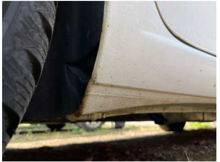
Schweller rechts (Rost, Lackschaden)
