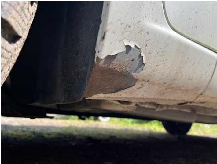
Schweller links (Rost, Lackschaden)
