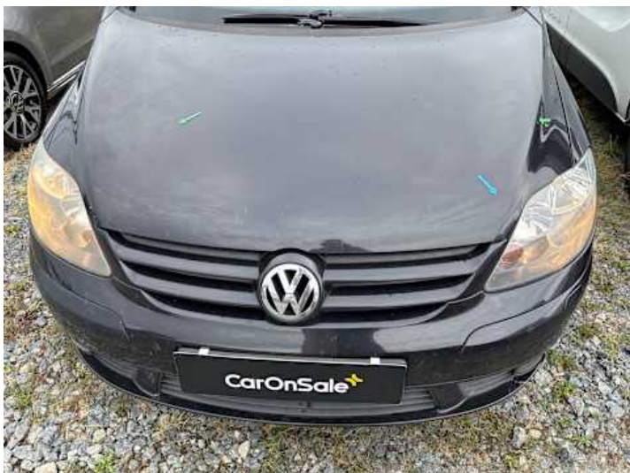
Motorhaube (Rost, Delle)
