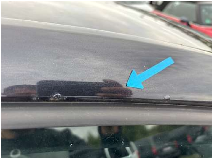
Seitenteil hinten rechts (Rost)
