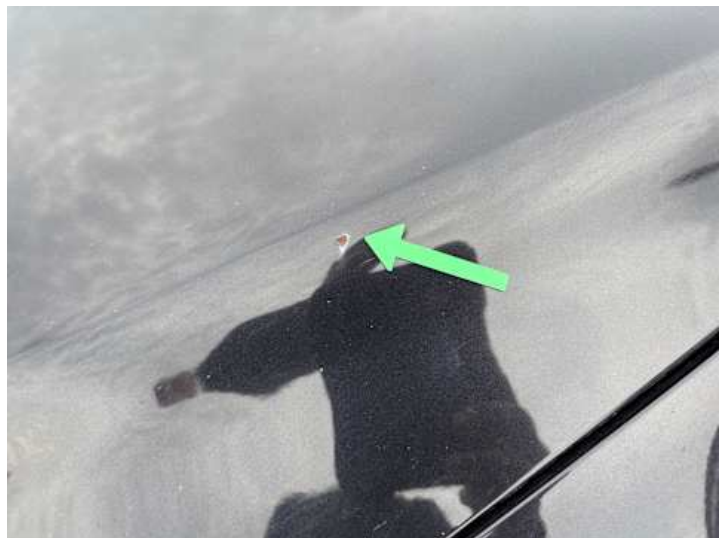
Motorhaube (Rost, Delle)
