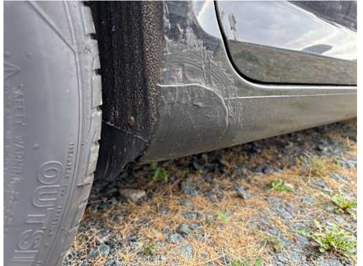
Schweller rechts (Unsachgemäß instand gesetzt)
