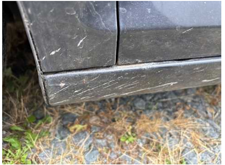
Schweller links (Rost)
