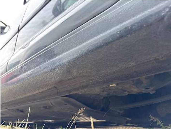
Schweller links (Verformung)
