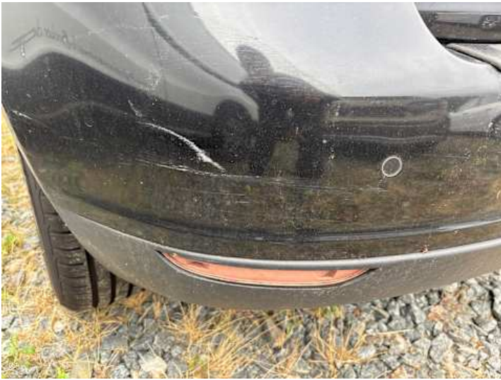
Stoßstange hinten (Riss/Bruch, Lackschaden)
