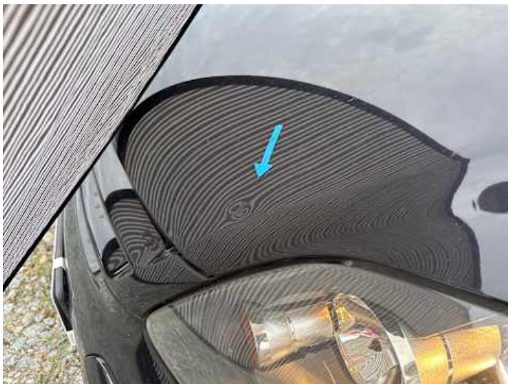
Motorhaube (Rost, Delle)
