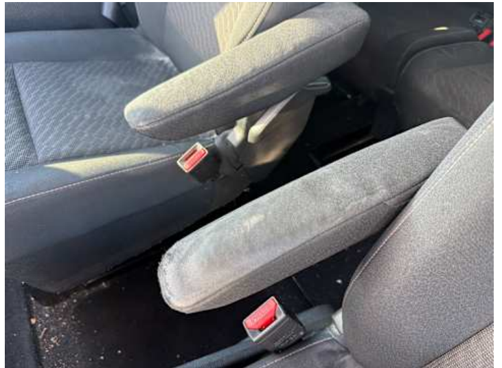
Innenraum (Verschmutzung, Verschleiß)
