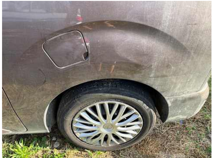
Seitenteil hinten links (Verformung)
