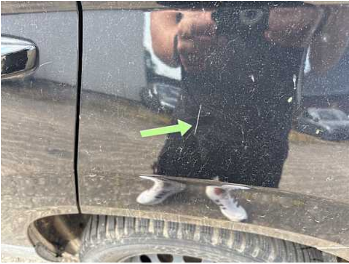
Seitenteil hinten links (Kratzer)
