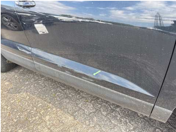
Beifahrertür (Kratzer, Lackschaden, Delle)
