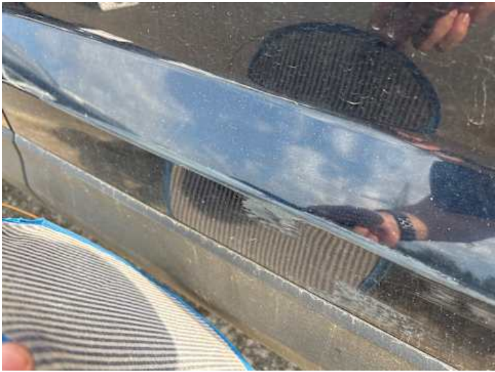
Beifahrertür (Kratzer, Lackschaden, Delle)
