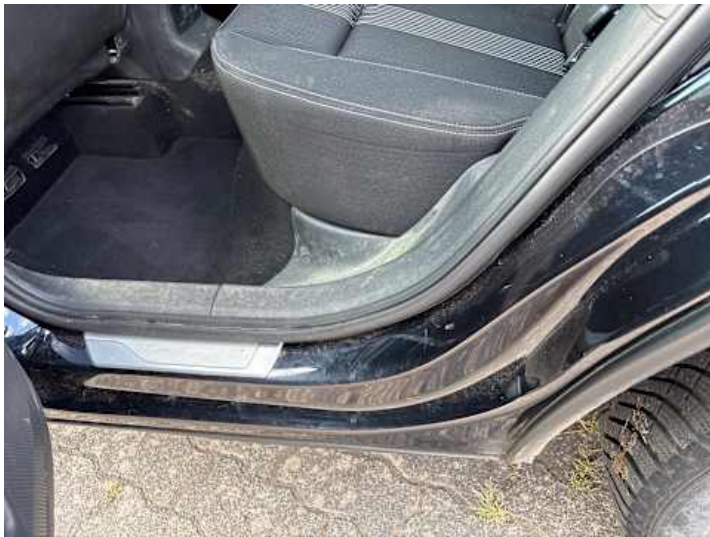
Türe hinten links (Kratzer)
