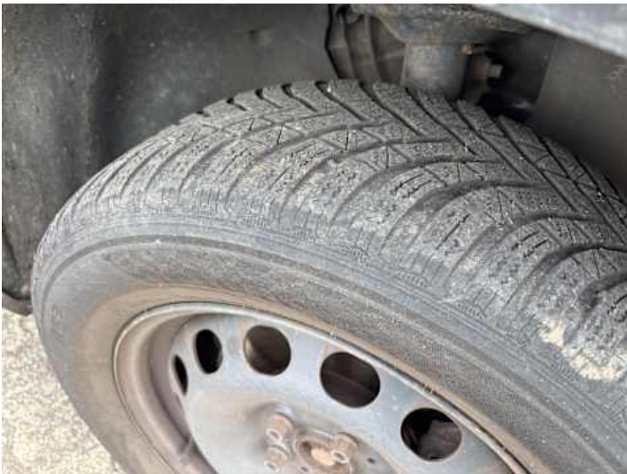
Rad (vehicle.damage-label.porous, Ungleichmäßig abgefahren)
