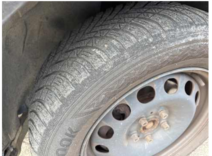
Rad (vehicle.damage-label.porous, Ungleichmäßig abgefahren)
