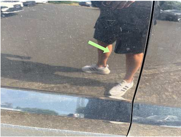
Türe hinten rechts (Kratzer, Delle)
