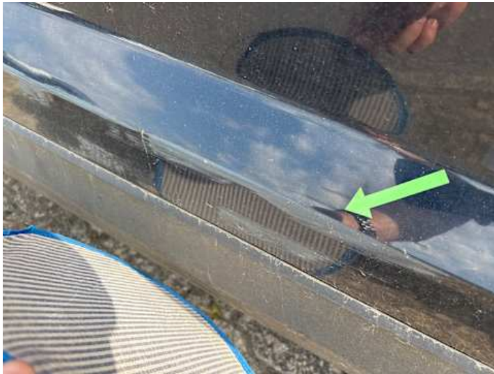
Beifahrertür (Kratzer, Lackschaden, Delle)
