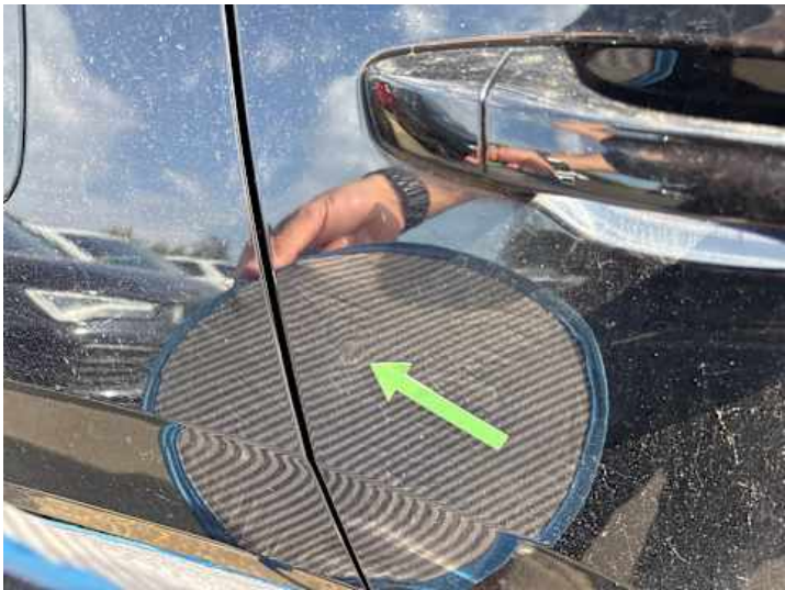
Türe hinten rechts (Kratzer, Delle)
