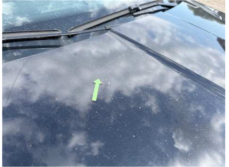
Motorhaube (Delle, Kratzer)
