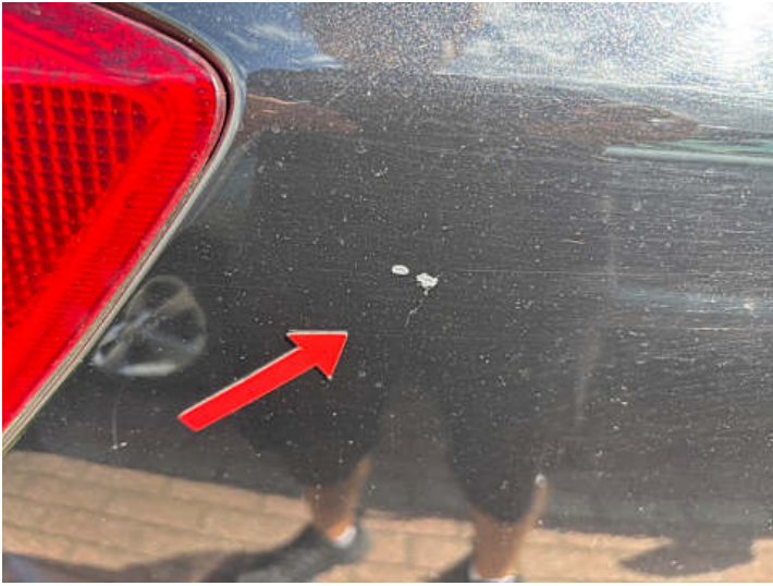
Seitenteil hinten rechts (Lackschaden)
