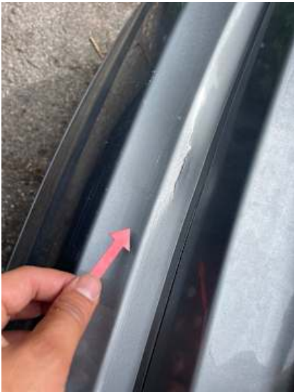
Stoßstange hinten (Riss/Bruch)
