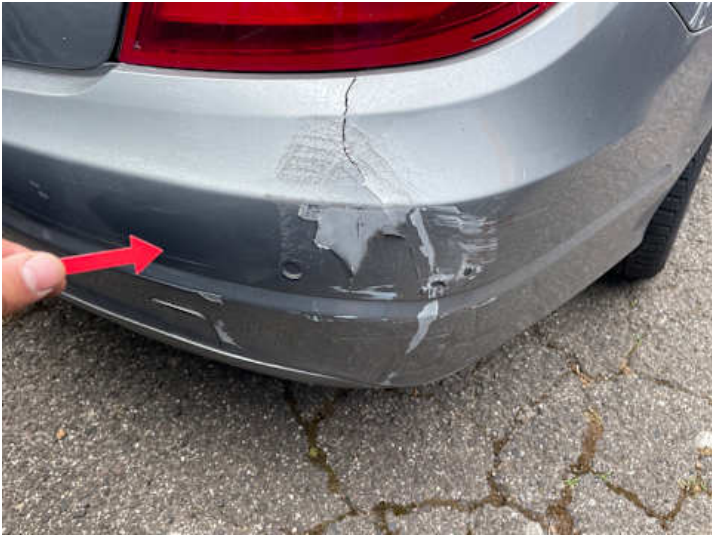
Stoßstange hinten (Riss/Bruch)
