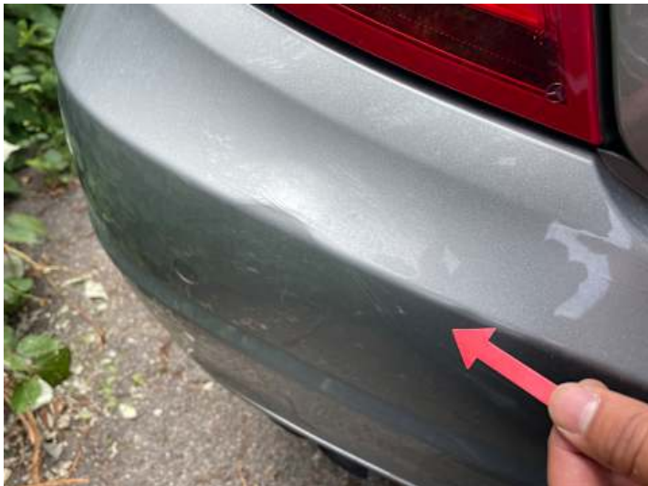
Stoßstange hinten (Riss/Bruch)
