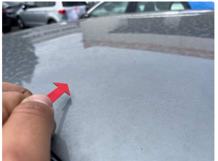
Dach (Delle, Lackschaden)
