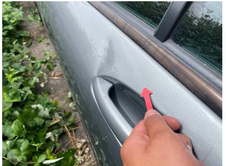
Türe hinten links (Delle)
