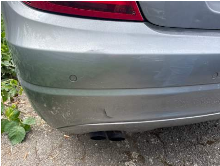
Stoßstange hinten (Riss/Bruch)
