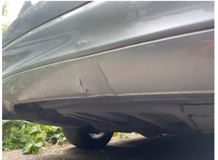
Stoßstange hinten (Riss/Bruch)
