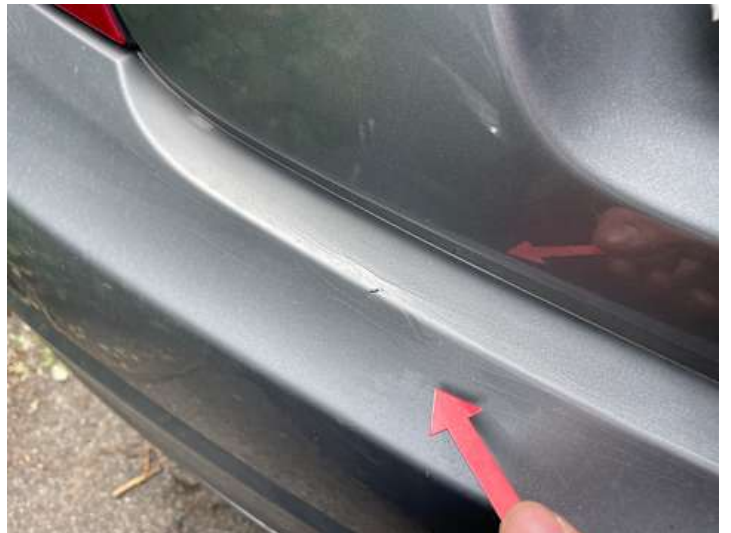
Stoßstange hinten (Riss/Bruch)
