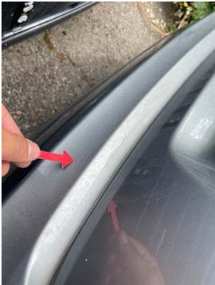
Stoßstange hinten (Riss/Bruch)
