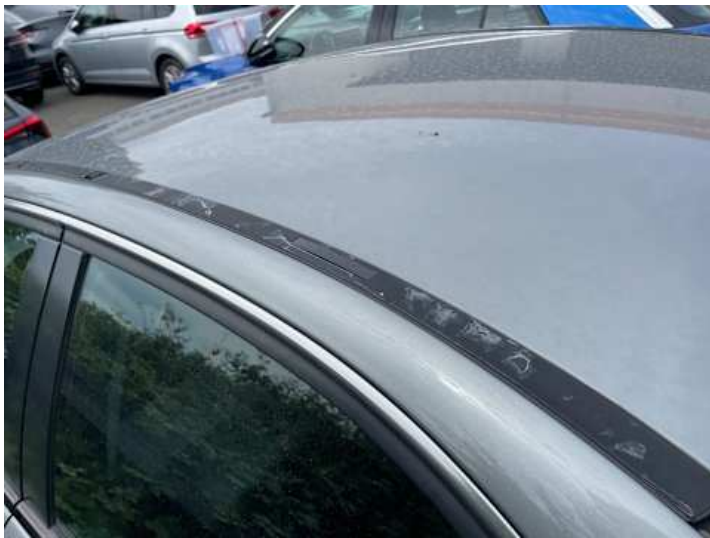
Dach (Delle, Lackschaden)
