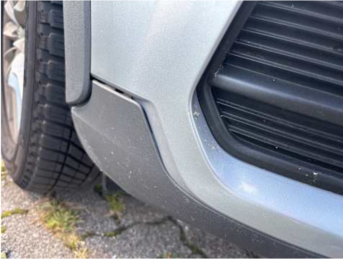
Stoßstange vorne (Spaltmaße ungenau)
