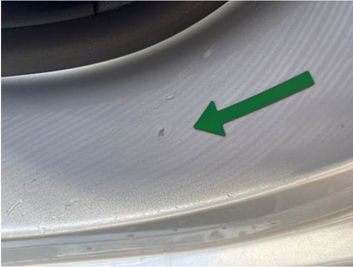
Schweller links (Kratzer, Delle)
