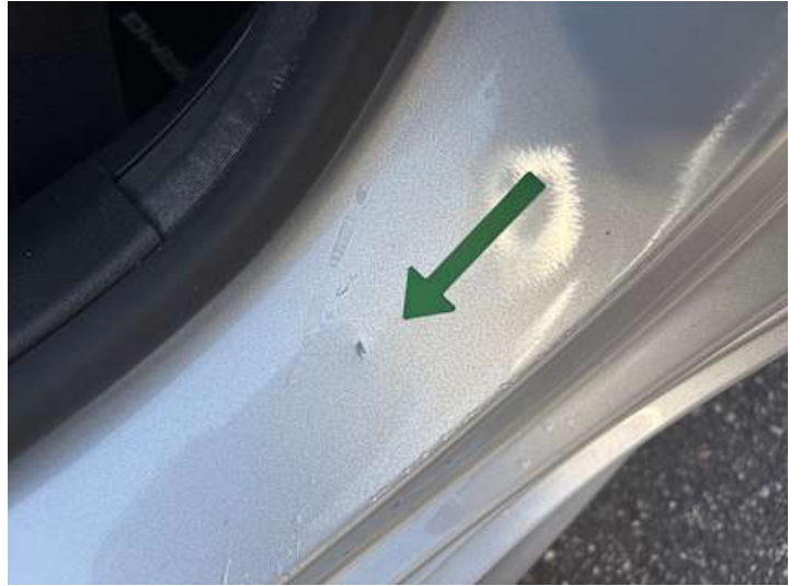
Schweller links (Kratzer, Delle)
