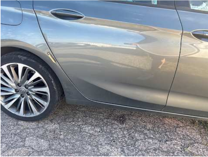
Seitenteil hinten rechts (Lackschaden, Verformung)
