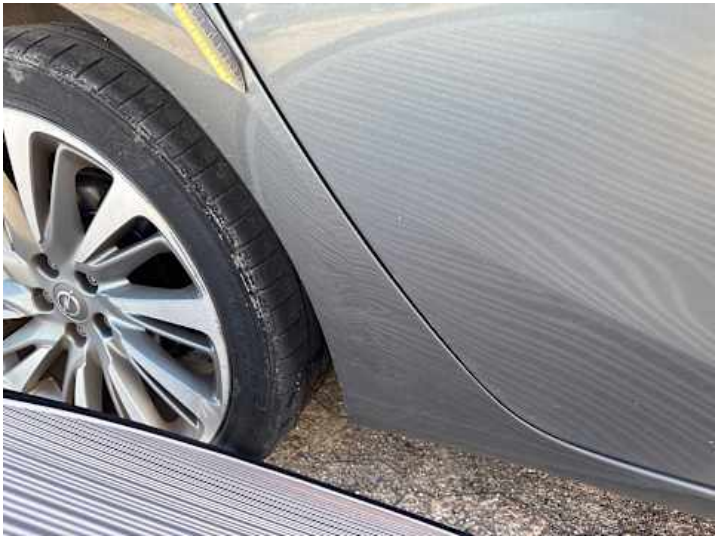
Seitenteil hinten rechts (Lackschaden, Verformung)
