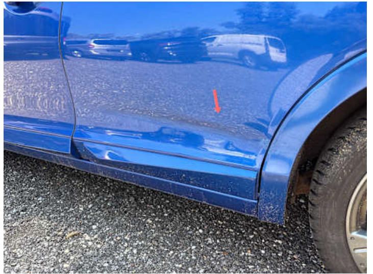
Türe hinten links (Verformung, Kratzer, Lackschaden)
