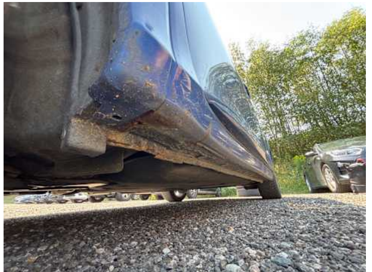
Schweller links (Rost)
