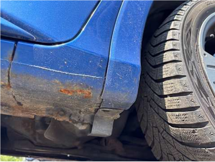
Kotflügel vorne rechts (Rost)
