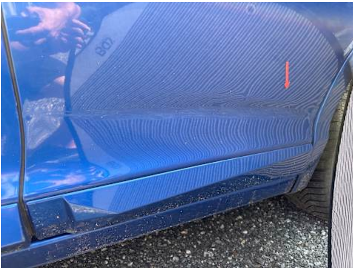
Türe hinten links (Verformung, Kratzer, Lackschaden)
