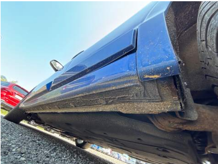
Schweller links (Rost)
