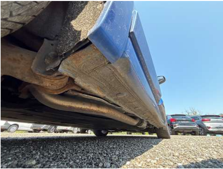
Schweller rechts (Rost)
