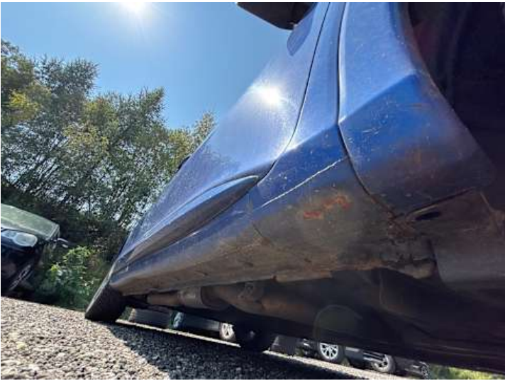
Schweller rechts (Rost)
