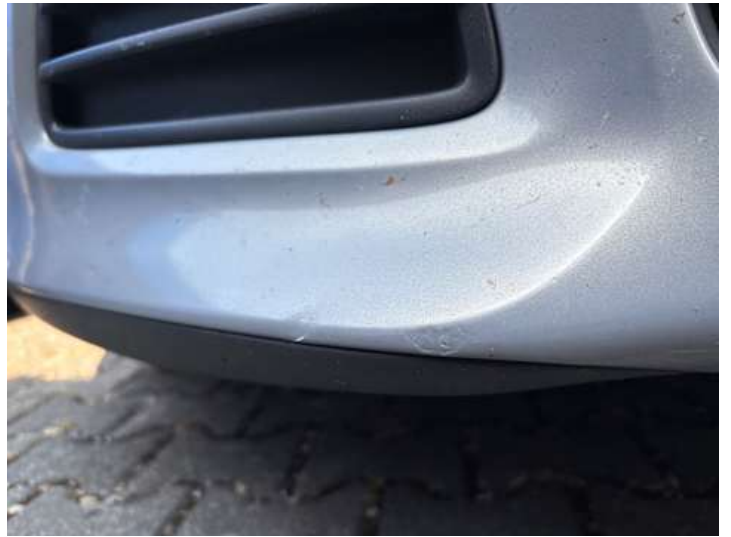
Stoßstange vorne (Verformung)
