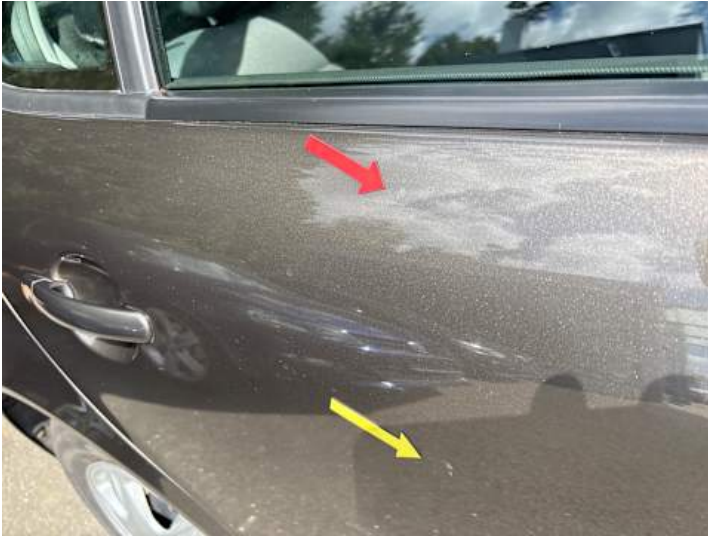
Türe hinten rechts (Lackschaden)
