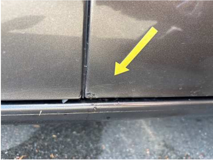
Türe hinten links (Rost)
