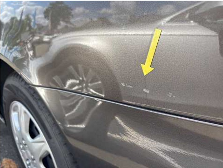
Seitenteil hinten links (Lackschaden)
