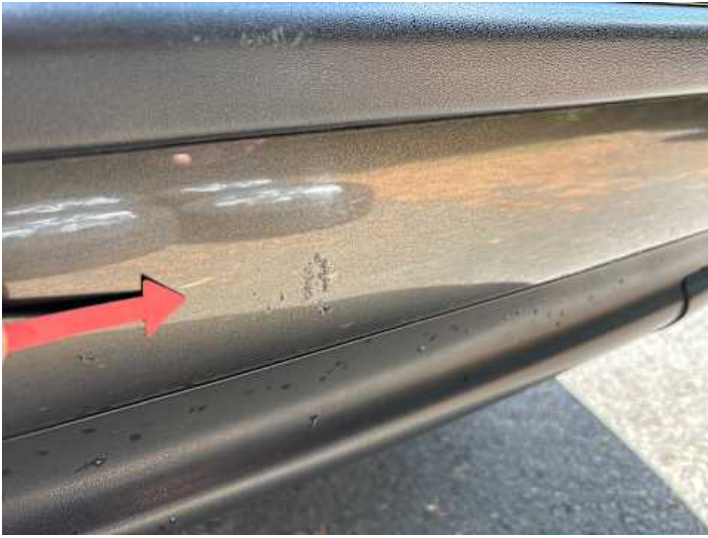
Stoßstange hinten (Unsachgemäß instand gesetzt, Lackschaden)
