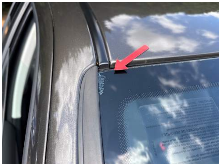
Windschutzscheibe (Anderer Schaden): Luftzieher
