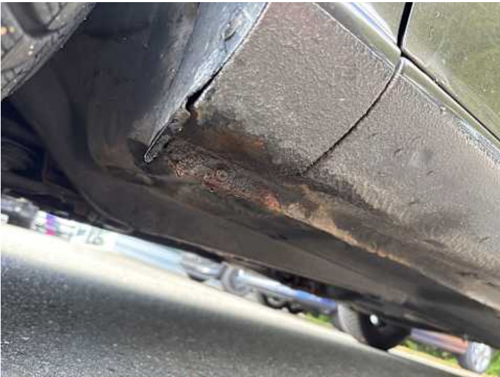
Schweller links (Rost)
