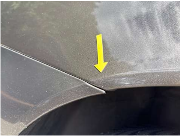
Seitenteil hinten rechts (Rost)
