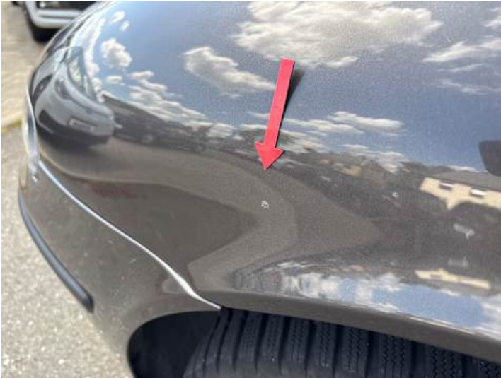
Kotflügel vorne links (Rost, Lackschaden)
