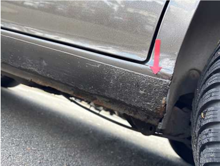
Schweller links (Rost)
