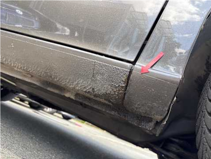
Schweller rechts (Rost)
