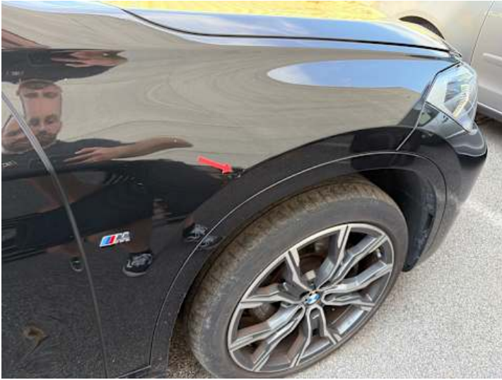
Kotflügel vorne rechts (Delle, Kratzer)
