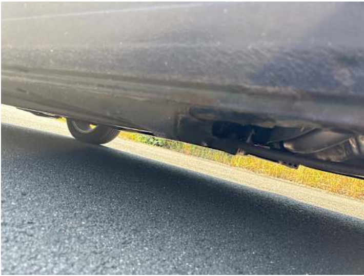
Schweller links (Rost)
