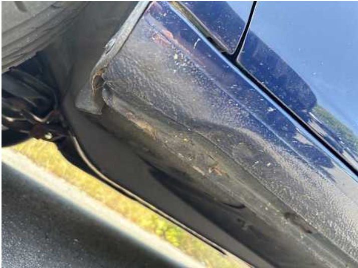
Schweller links (Verformung)
