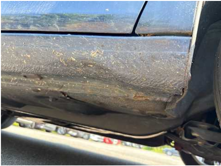
Schweller rechts (Verformung, Rost)
