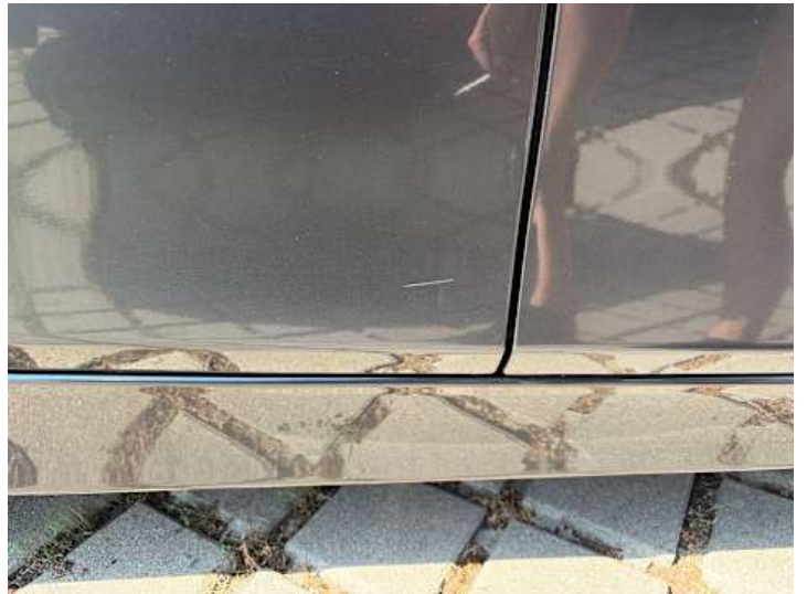
Türe hinten rechts (Kratzer, Lackschaden)
