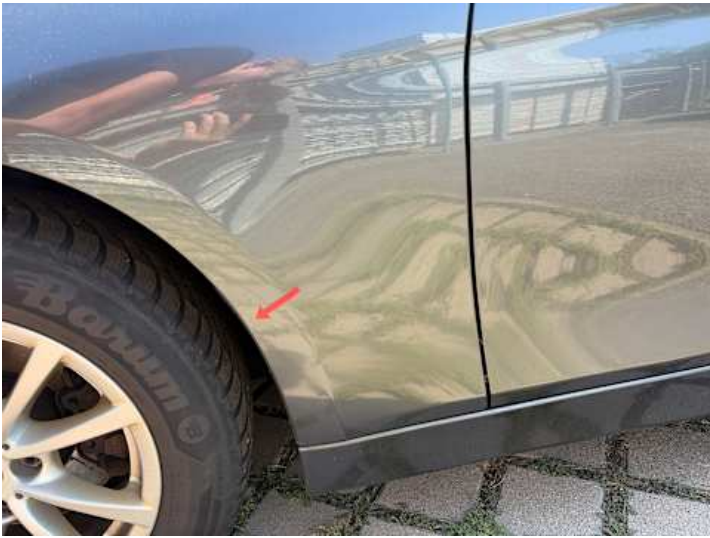
Kotflügel vorne links (Rost, Lackschaden)
