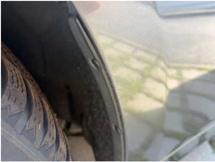
Kotflügel vorne links (Rost, Lackschaden)
