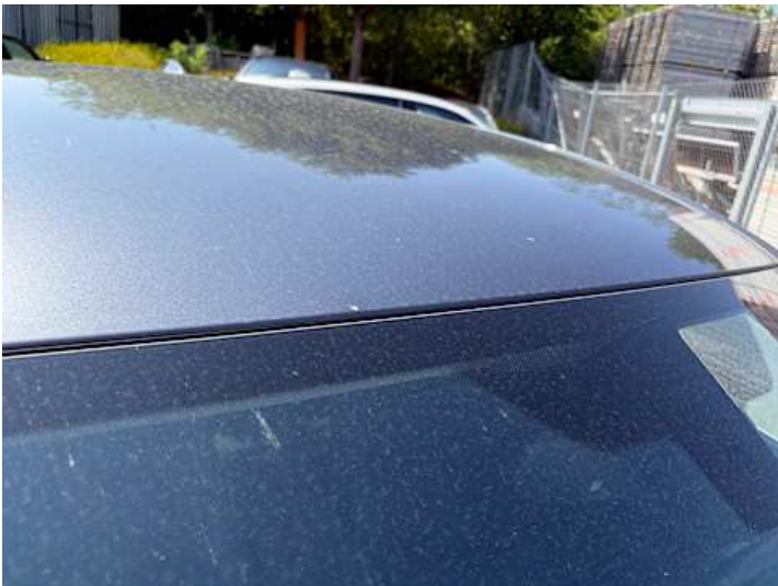
Dach (Lackschaden, Steinschlag)
