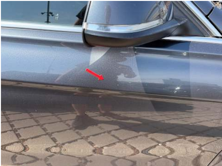
Beifahrtür (Kratzer, Lackschaden)
