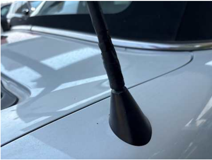
Seitenteil hinten rechts (Anderer Schaden): Antenne beschädigt
