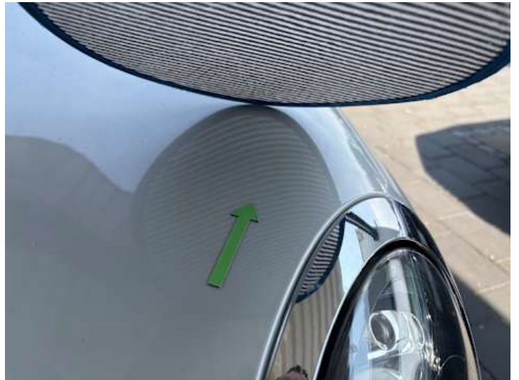
Motorhaube (Steinschlag, Delle)
