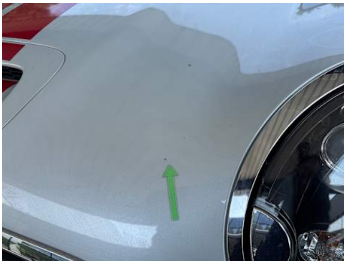
Motorhaube (Steinschlag, Delle)
