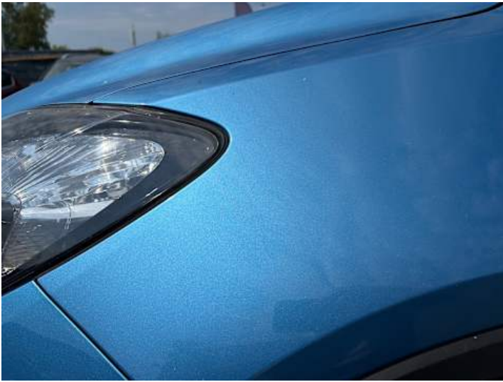
Kotflügel vorne links (Steinschlag, Lackschaden)
