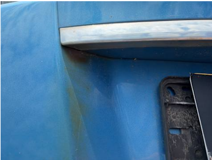
Heckklappe (Rost, Lackschaden)
