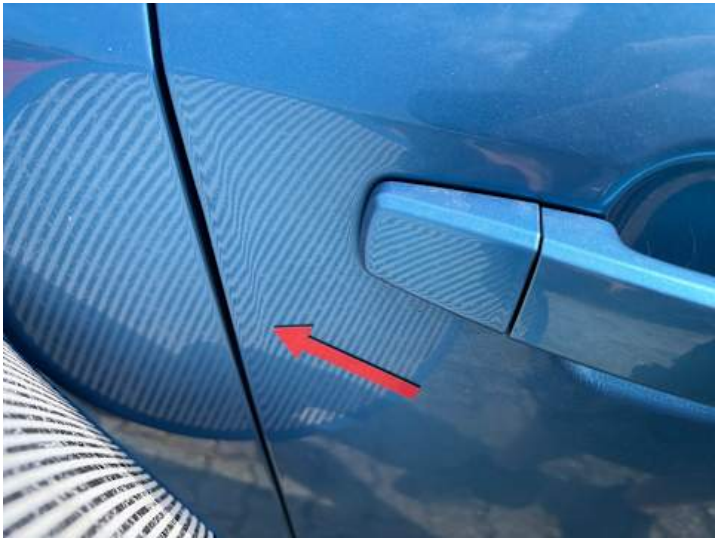
Beifahrtür (Delle, Verformung)
