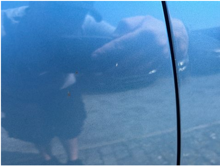
Türe hinten rechts (Lackschaden)
