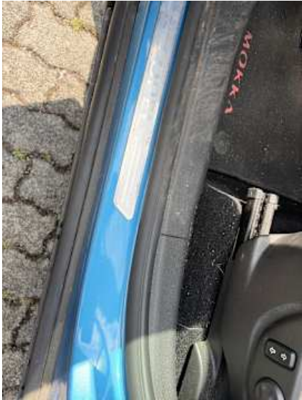
Schweller links (Kratzer)
