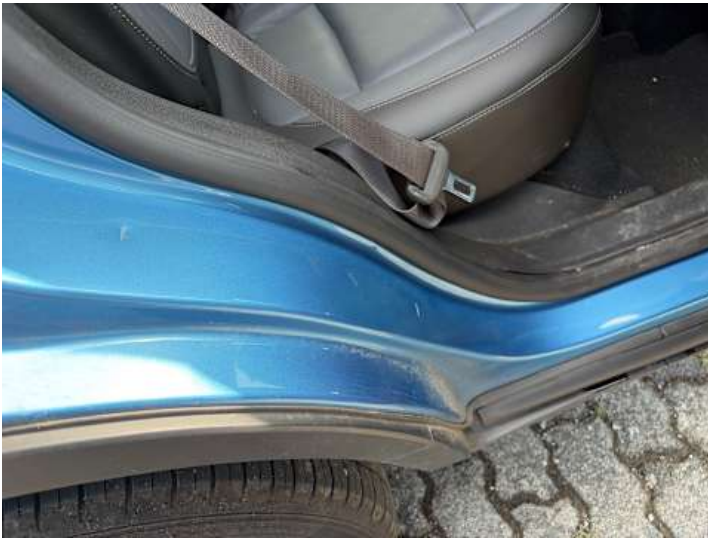
Seitenteil hinten rechts (Lackschaden, Delle)
