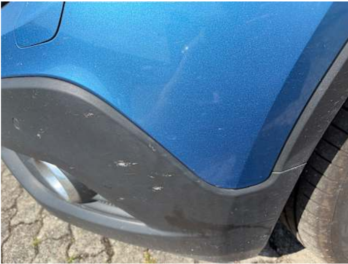
Stoßstange vorne (Verformung)
