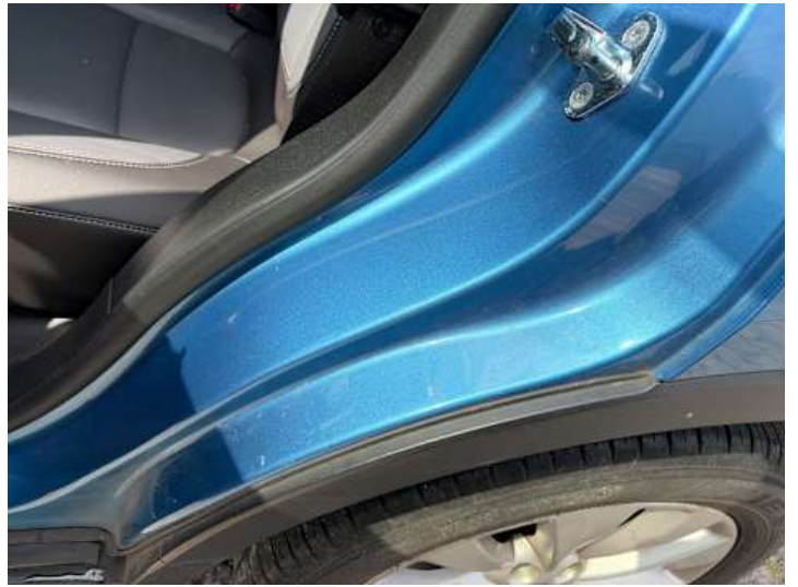
Seitenteil hinten links (Kratzer, Lackschaden)
