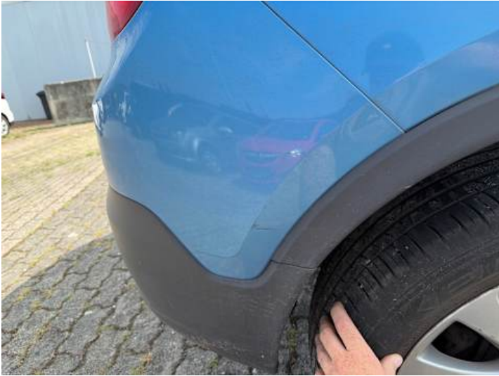
Stoßstange hinten (Kratzer, Lackschaden)
