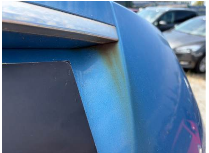
Heckklappe (Rost, Lackschaden)
