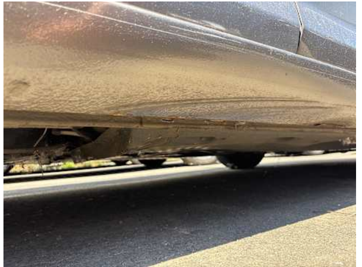
Schweller rechts (Verformung, Rost)
