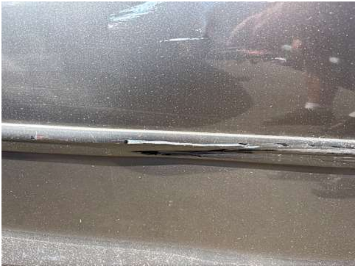
Beifahrertür (Kratzer, Verformung)
