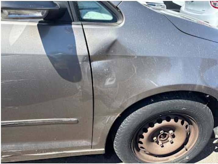
Kotflügel vorne rechts (Verformung, Rost)
