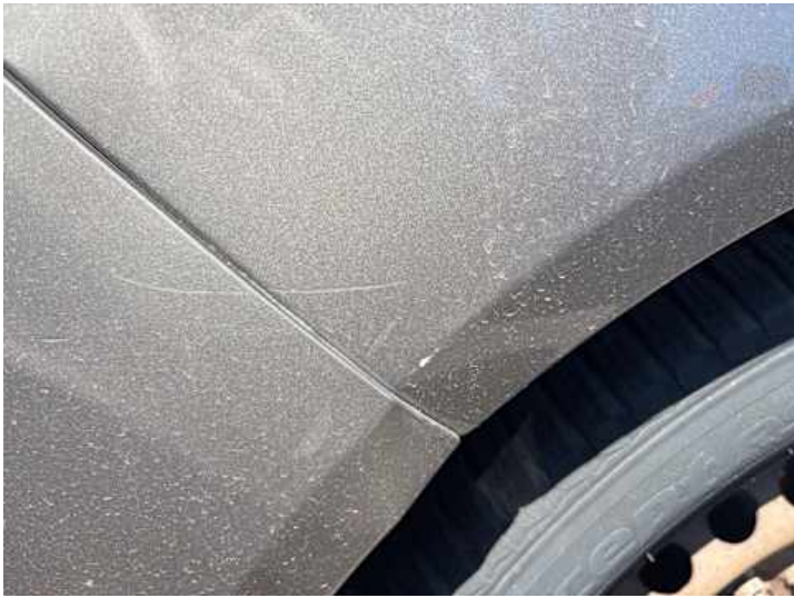
Seitenteil hinten rechts (Verformung, Rost, Kratzer)
