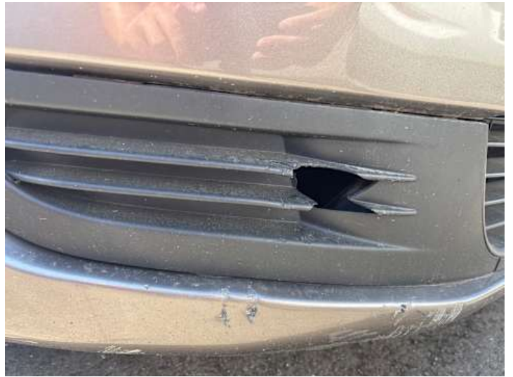
Stoßstange vorne (Kratzer, Spaltmaße ungenau, Riss/Bruch)
