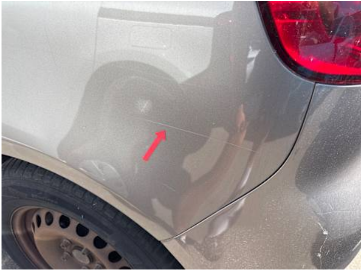
Seitenteil hinten links (Kratzer, Rost, Delle)
