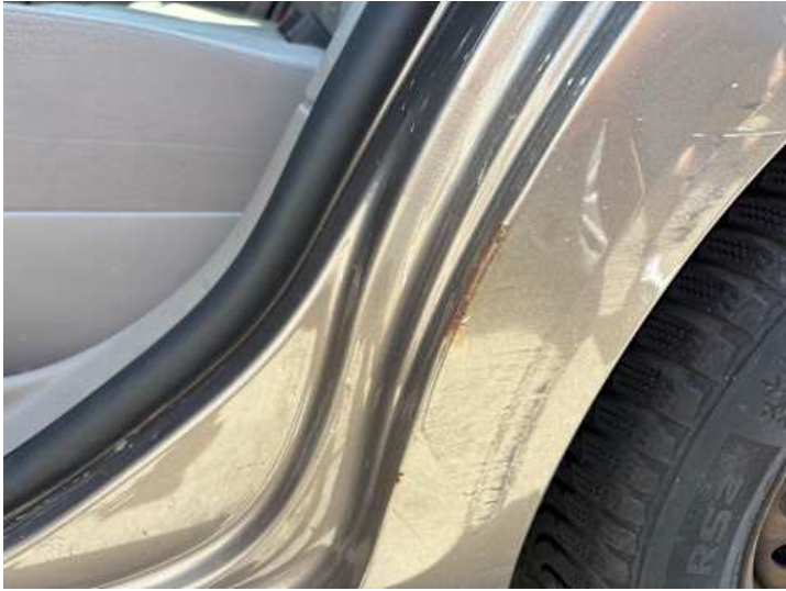
Seitenteil hinten links (Kratzer, Rost, Delle)
