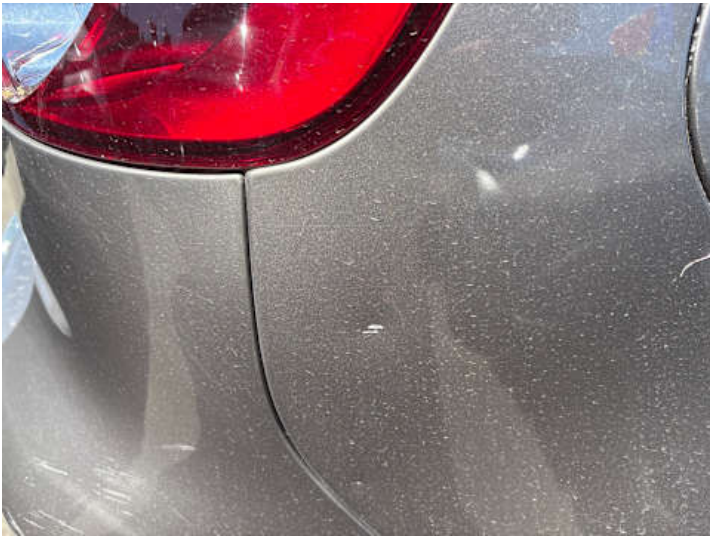
Seitenteil hinten rechts (Verformung, Rost, Kratzer)
