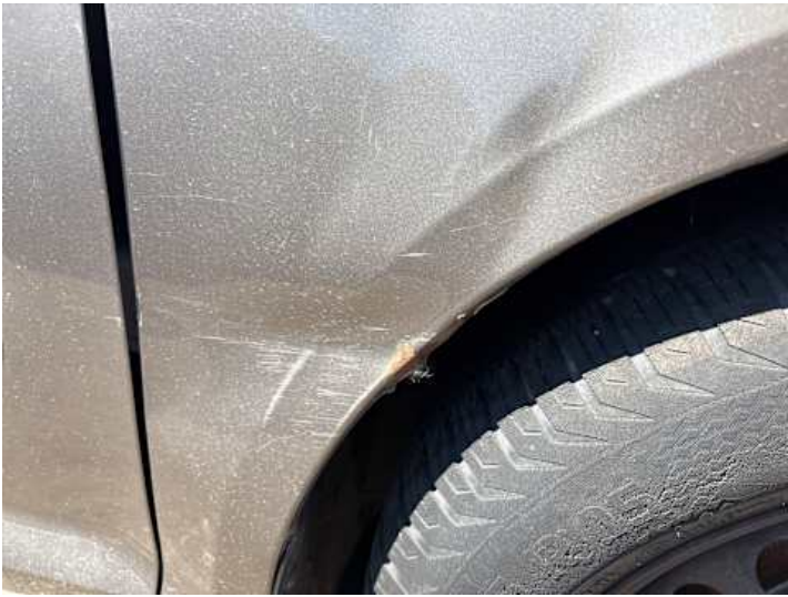
Kotflügel vorne rechts (Verformung, Rost)
