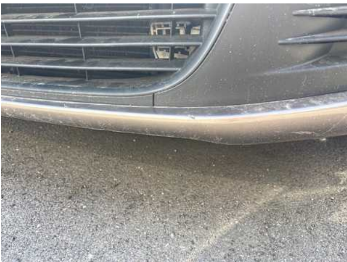
Stoßstange vorne (Kratzer, Spaltmaße ungenau, Riss/Bruch)
