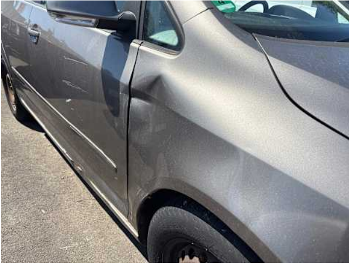
Kotflügel vorne rechts (Verformung, Rost)
