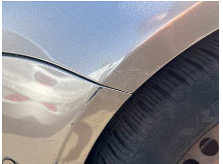
Kotflügel vorne links (Kratzer)
