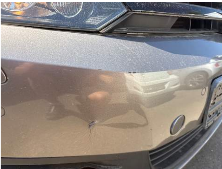
Stoßstange vorne (Kratzer, Spaltmaße ungenau, Riss/Bruch)
