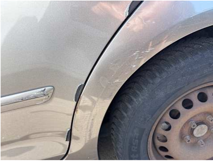
Seitenteil hinten links (Kratzer, Rost, Delle)
