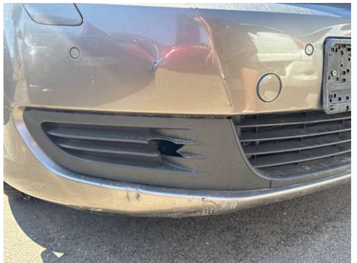
Stoßstange vorne (Kratzer, Spaltmaße ungenau, Riss/Bruch)
