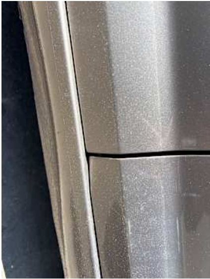
Beifahrtür (Kratzer, Verformung)
