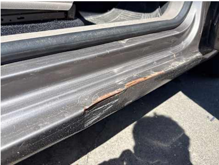
Schweller rechts (Verformung, Rost)
