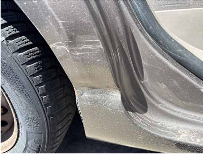
Seitenteil hinten rechts (Verformung, Rost, Kratzer)
