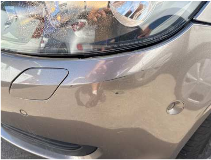
Stoßstange vorne (Kratzer, Spaltmaße ungenau, Riss/Bruch)
