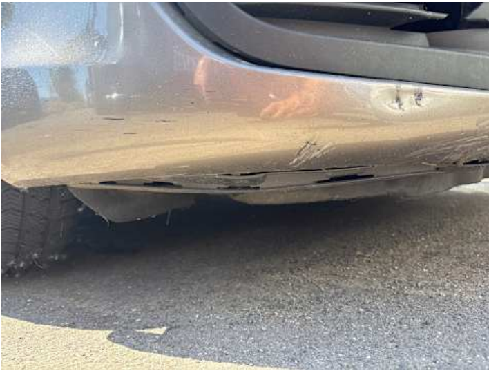
Stoßstange vorne (Kratzer, Spaltmaße ungenau, Riss/Bruch)
