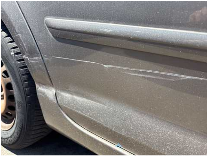
Türe hinten rechts (Kratzer, Delle)
