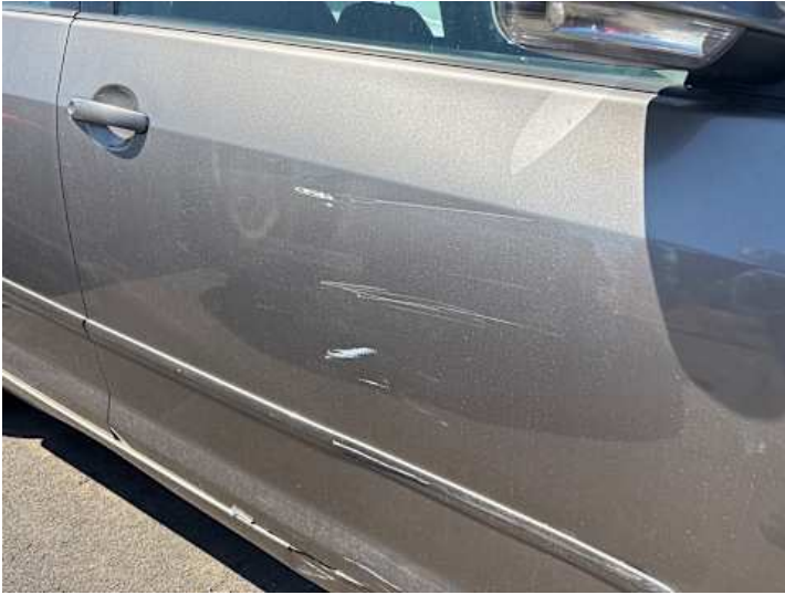
Beifahrertür (Kratzer, Verformung)
