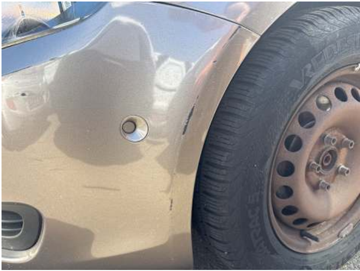
Stoßstange vorne (Kratzer, Spaltmaße ungenau, Riss/Bruch)
