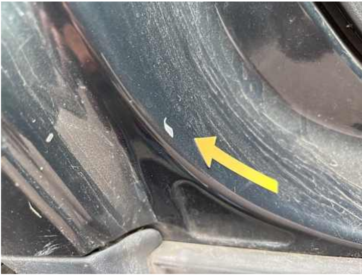
Schweller rechts (Kratzer)
