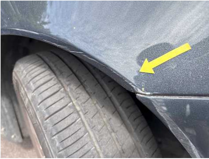
Kotflügel vorne rechts (Kratzer)
