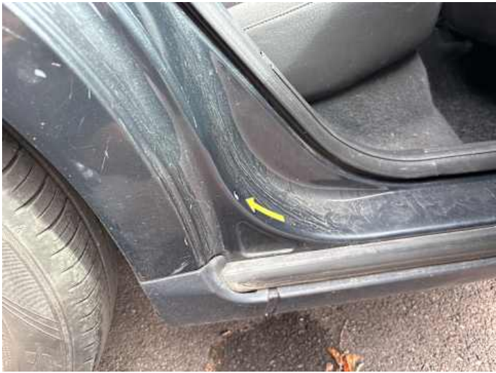
Schweller rechts (Kratzer)
