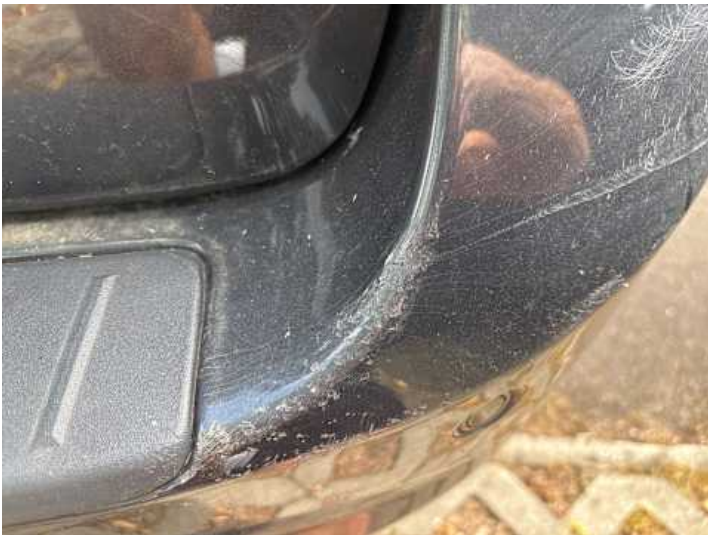
Stoßstange hinten (Riss/Bruch)
