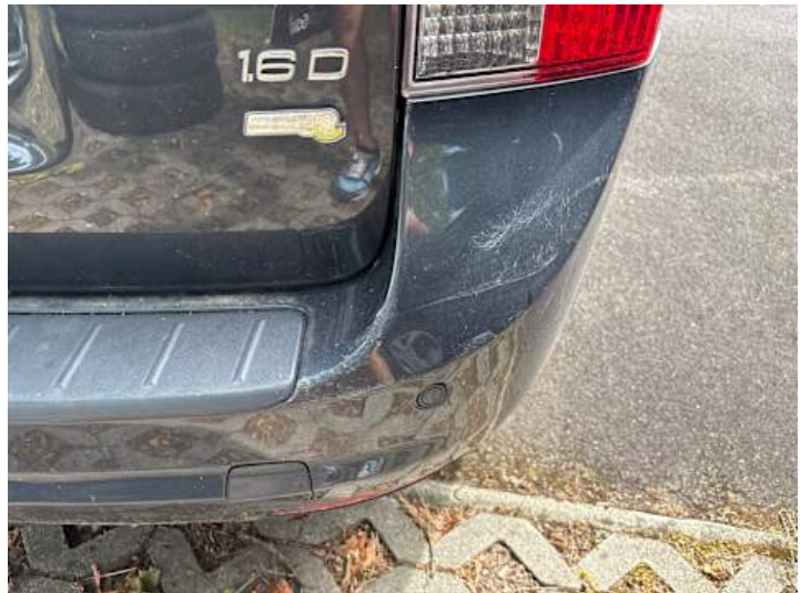
Stoßstange hinten (Riss/Bruch)
