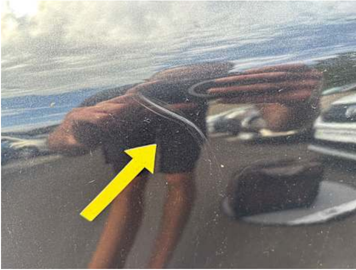
Kotflügel vorne links (Kratzer)
