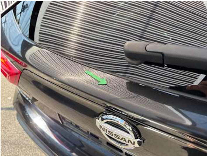
Heckklappe (Kratzer, Delle)
