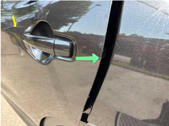
Türe hinten links (Lackschaden, Kratzer)
