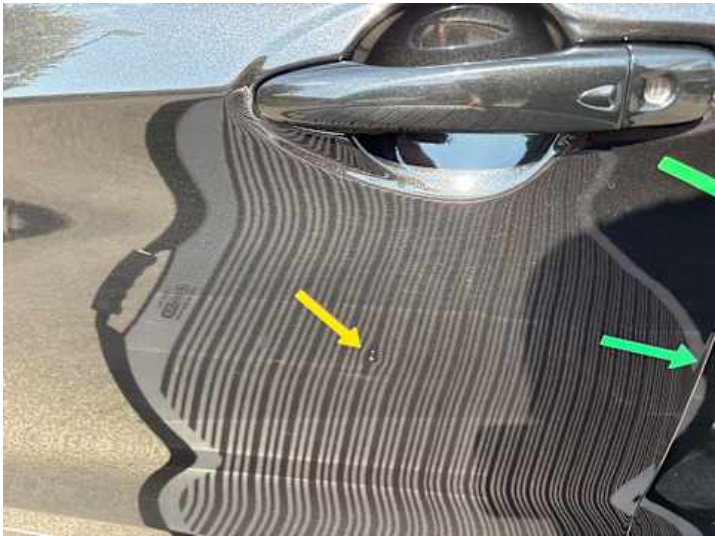
Fahrer­tür (Kratzer, Delle, Lackschaden)
