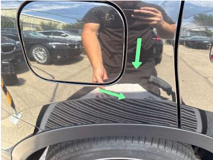
Seitenteil hinten rechts (Kratzer, Lackschaden, Delle)
