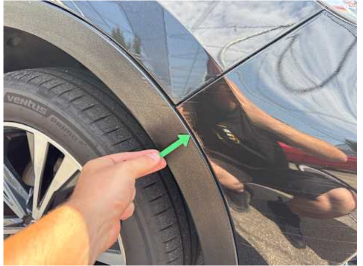
Stoßstange vorne (Kratzer, Lackschaden, Unsachgemäß instand gesetzt)
