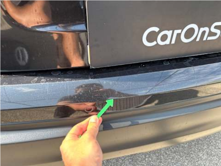
Stoßstange hinten (Kratzer, Lackschaden)
