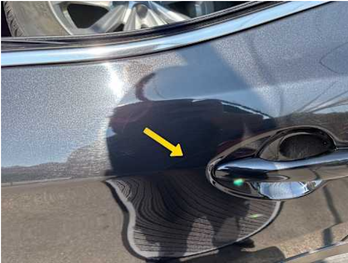
Türe hinten links (Lackschaden, Kratzer)
