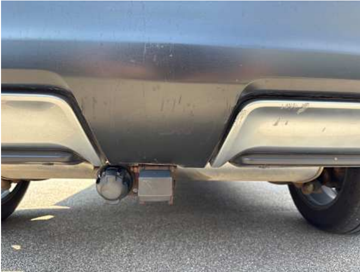
Stoßstange hinten (Kratzer, Lackschaden)
