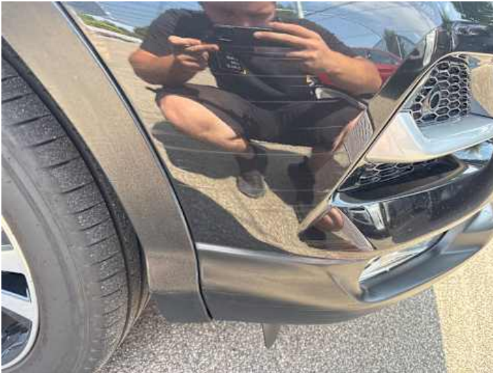
Stoßstange vorne (Kratzer, Lackschaden, Unsachgemäß instand gesetzt)
