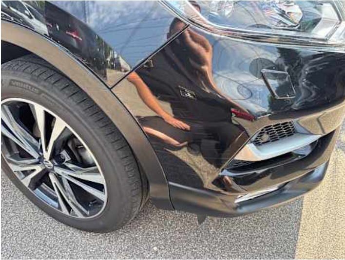
Stoßstange vorne (Kratzer, Lackschaden, Unsachgemäß instand gesetzt)
