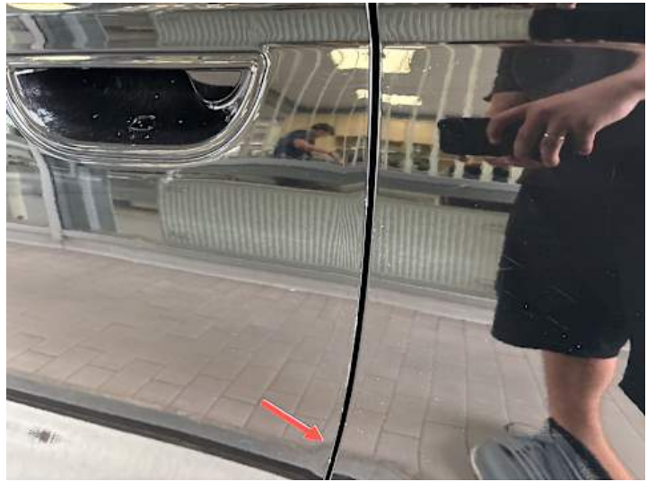
Fahrtür (Kratzer, Delle, Verformung)
