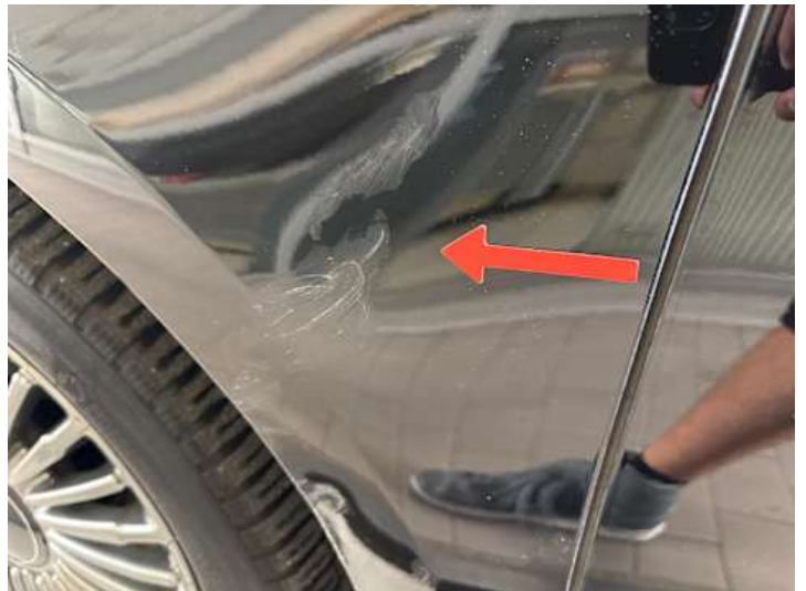
Kotflügel vorne links (Kratzer, Unsachgemäß instand gesetzt)
