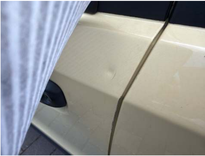
Fahrertür (Kratzer, Delle, Ausgeblichen/Matt)
