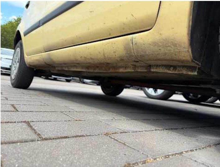
Schweller rechts (Rost, Unsachgemäß instand gesetzt)
