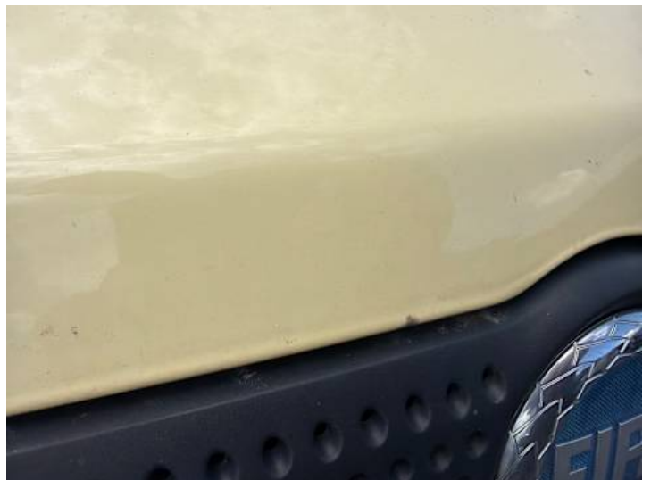
Motorhaube (Ausgeblichen/Matt, Kratzer)
