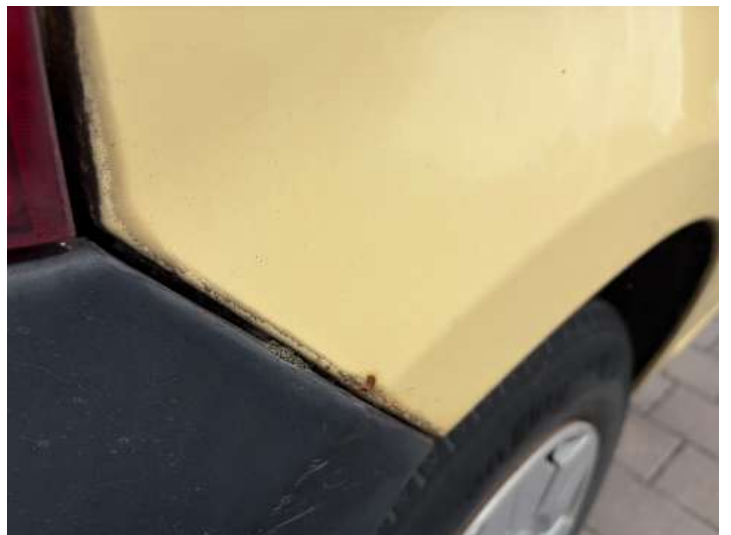
Seitenteil hinten rechts (Rost, Ausgeblichen/Matt)
