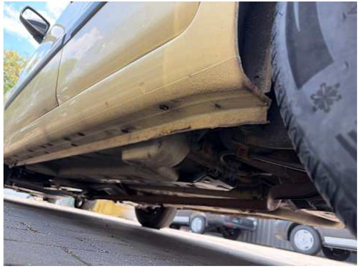
Schweller links (Rost)
