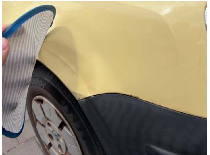
Kotflügel vorne rechts (Verformung, Kratzer, Rost, Ausgeblichen/Matt)
