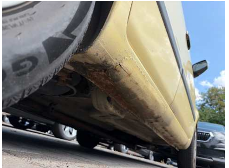
Schweller rechts (Rost, Unsachgemäß instand gesetzt)
