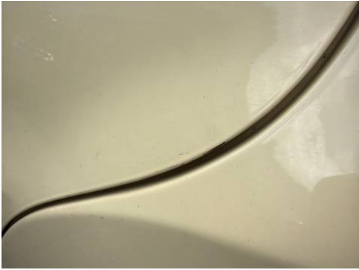
Türe hinten links (Ausgeblichen/Matt, Kratzer)
