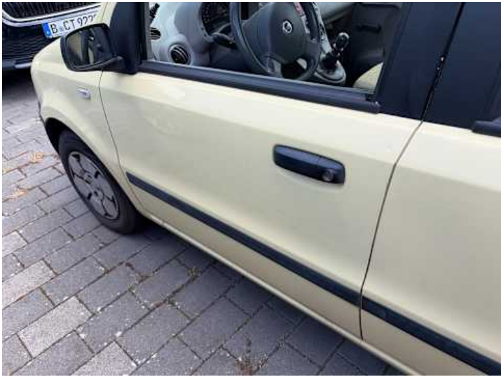
Fahrertür (Kratzer, Delle, Ausgeblichen/Matt)
