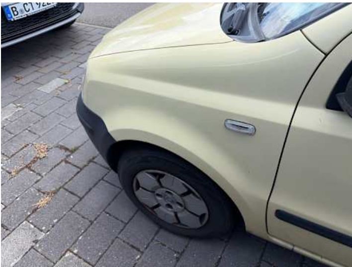
Kotflügel vorne links (Kratzer, Ausgeblichen/Matt, Rost)
