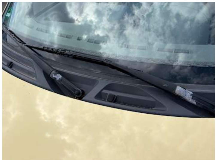
Windschutzscheibe (Anderer Schaden): Korrosion Wischer;
