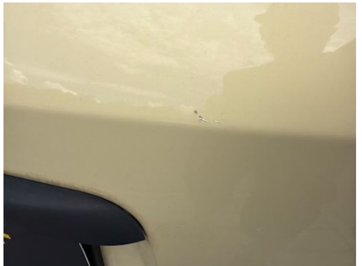
Heckklappe (Ausgeblichen/Matt, Kratzer)
