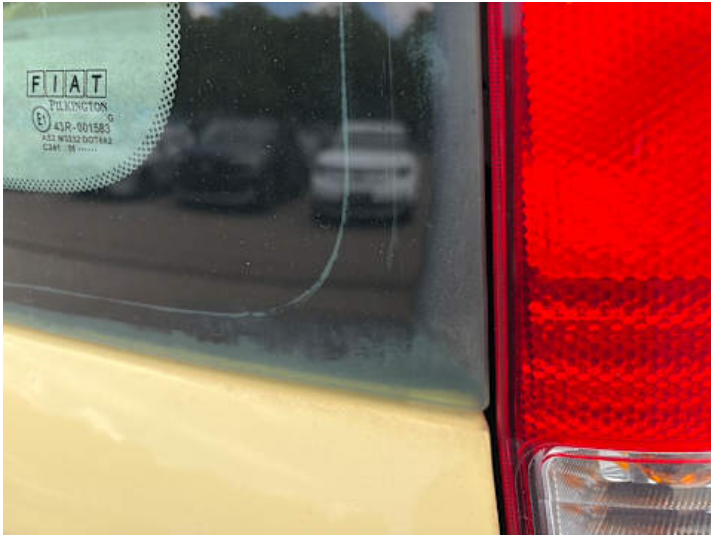
Rückscheibe (Anderer Schaden): Kleber löst sich;
