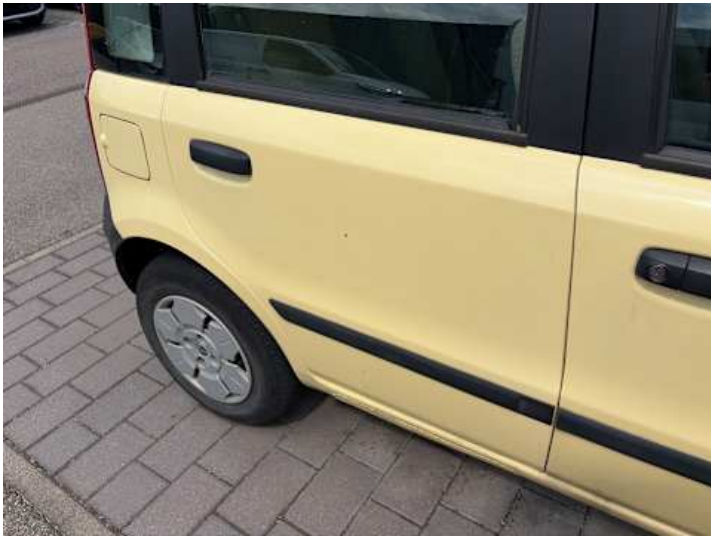
Türe hinten rechts (Ausgeblichen/Matt, Kratzer)
