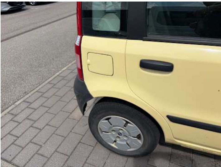
Seitenteil hinten rechts (Rost, Ausgeblichen/Matt)
