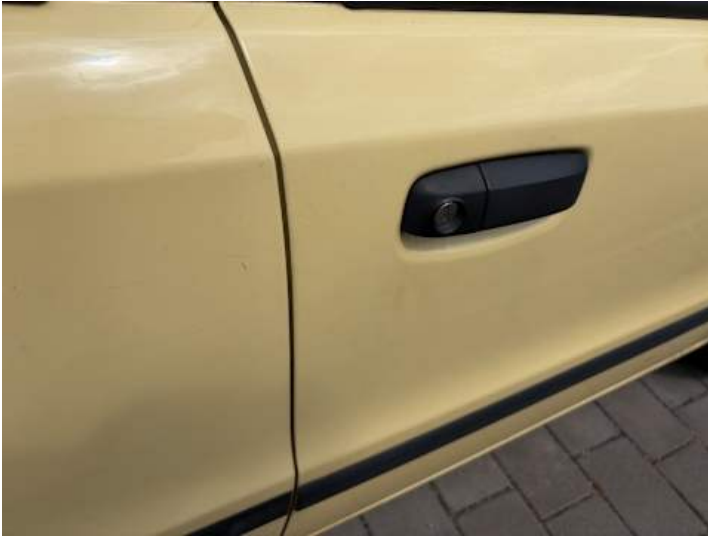
Beifahrertür (Kratzer, Ausgeblichen/Matt)
