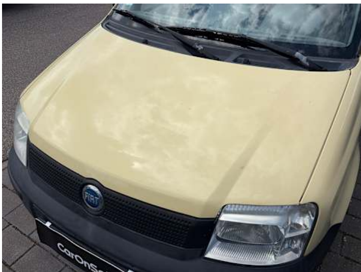
Motorhaube (Ausgeblichen/Matt, Kratzer)
