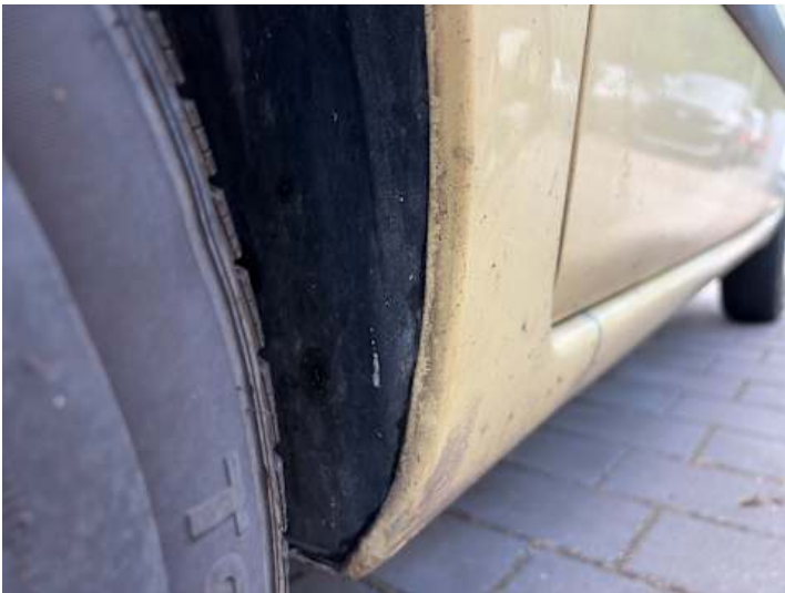
Kotflügel vorne links (Kratzer, Ausgeblichen/Matt, Rost)
