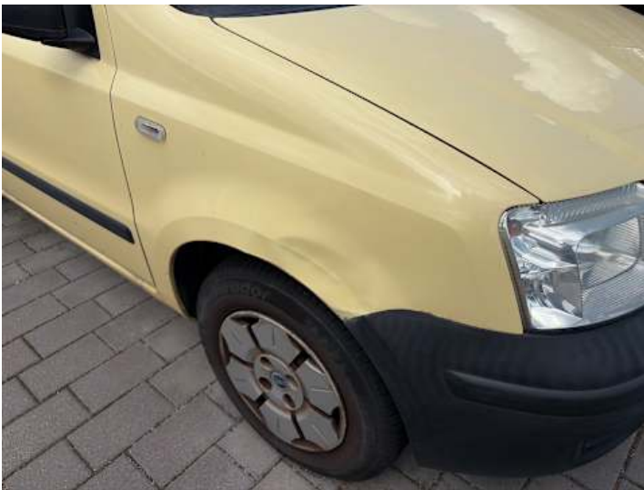
Kotflügel vorne rechts (Verformung, Kratzer, Rost, Ausgeblichen/Matt)
