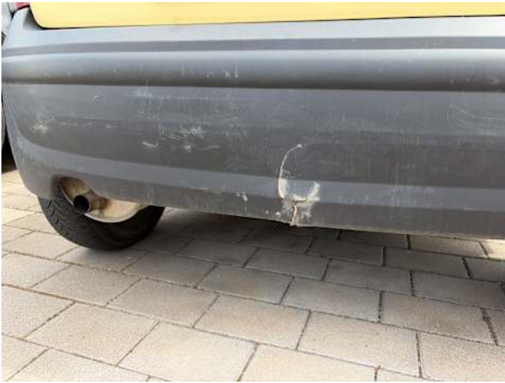
Stoßstange hinten (Riss/Bruch)
