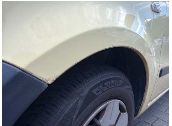
Kotflügel vorne links (Kratzer, Ausgeblichen/Matt, Rost)
