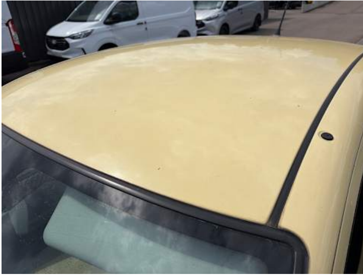
Dach (Kratzer, Rost)
