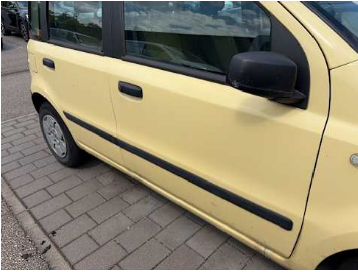
Beifahrertür (Kratzer, Ausgeblichen/Matt)
