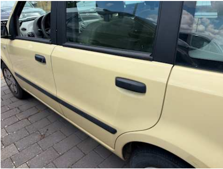
Türe hinten links (Ausgeblichen/Matt, Kratzer)
