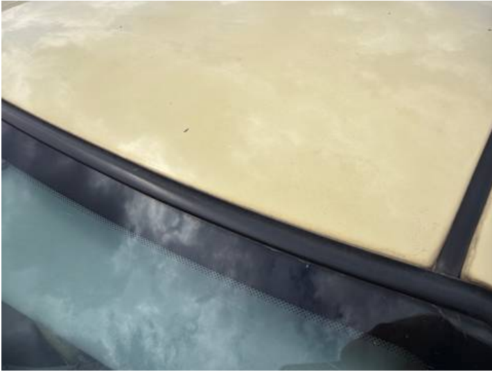
Dach (Kratzer, Rost)
