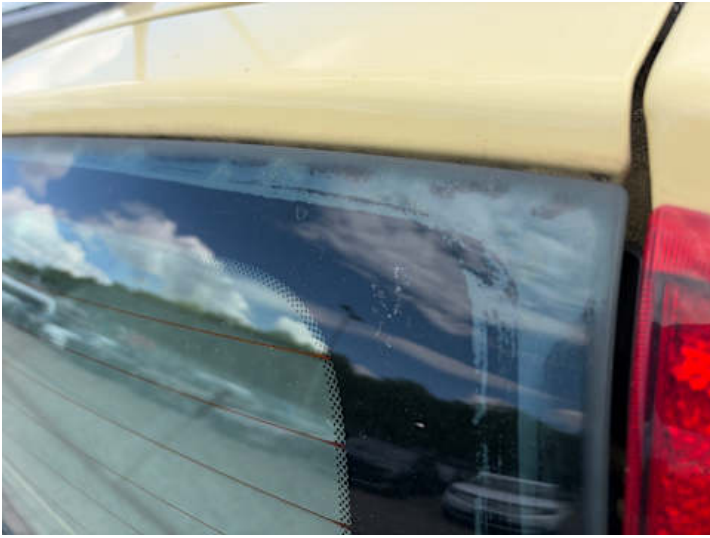
Rückscheibe (Anderer Schaden): Kleber löst sich;
