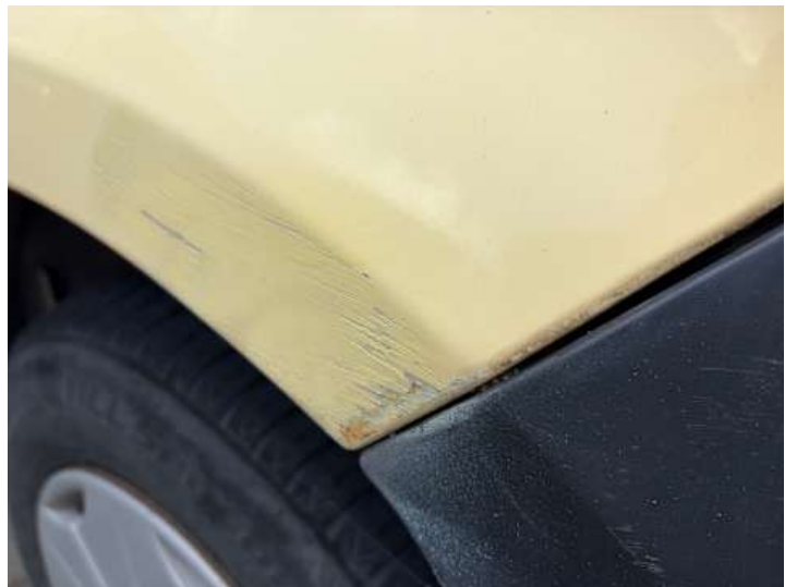
Seitenteil hinten links (Ausgeblichen/Matt, Rost, Kratzer)
