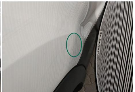
Seitenwand / Unten Rechts / Delle
