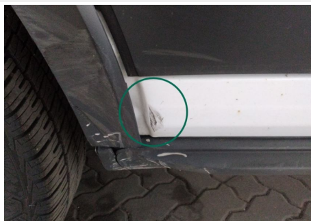
Tür / Vorne Links / Delle
