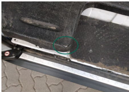
Kofferraumboden / Hinten / Gebrochen
