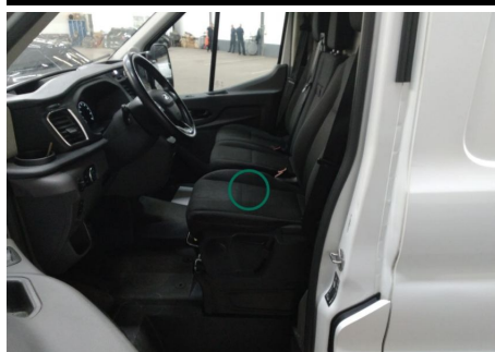
Polster Sitzfläche / Vorne Links / Brandstelle
