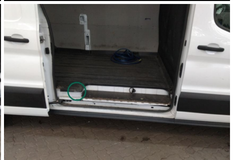
Kofferraumboden / Hinten / Gebrochen
