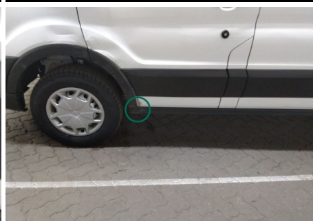
Schwellerabdeckung / Vorne Links / Gebrochen
