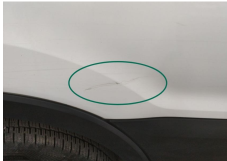
Seitenwand / Unten Rechts / Delle
