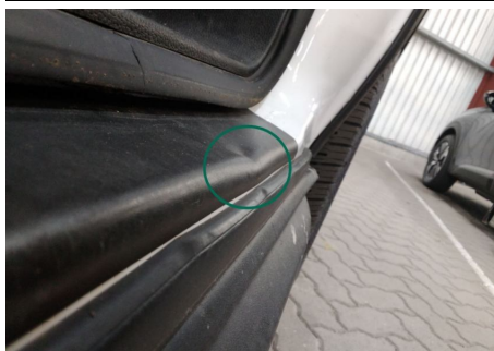
Türeinstieg / Vorne Rechts / Delle
