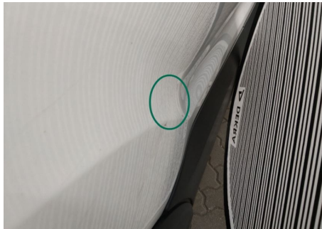
Seitenwand / Unten Rechts / Delle
