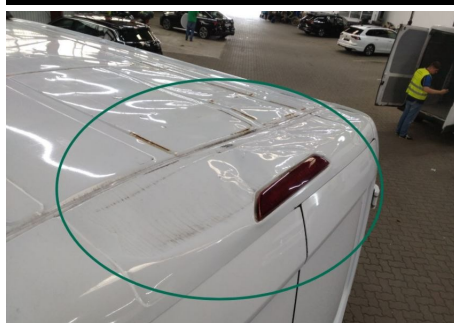
Dachholm / Hinten / Delle
