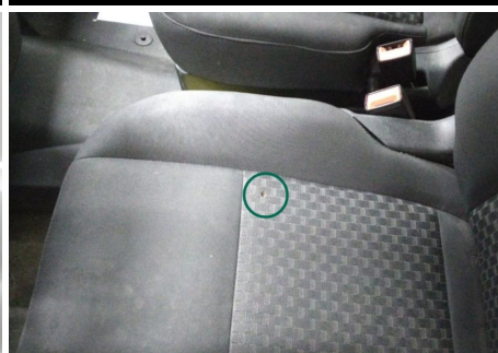
Polster Sitzfläche / Vorne Links / Brandstelle
