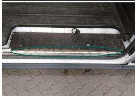
Holzboden / Rechts / Abgewetzt
