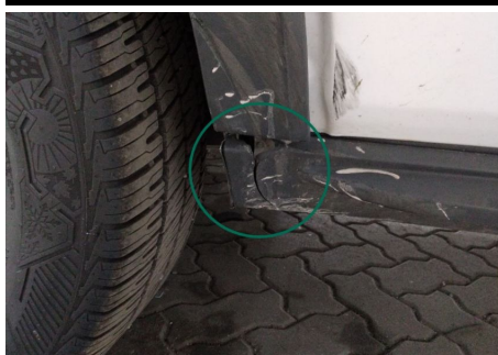
Schwellerabdeckung / Vorne Links / Gebrochen
