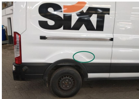
Seitenwand / Unten Rechts / Delle
