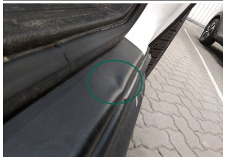
Türeinstieg / Vorne Rechts / Delle
