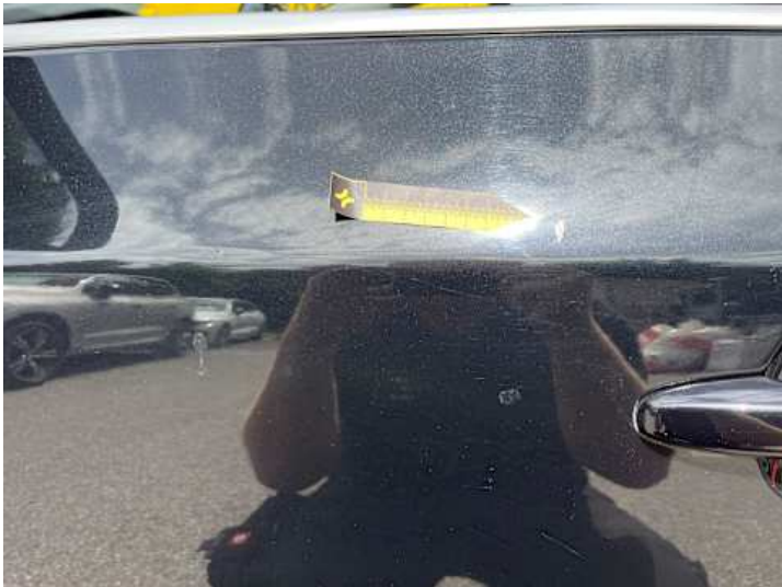
Fahrtür (Lackschaden, Unsachgemäß instand gesetzt)
