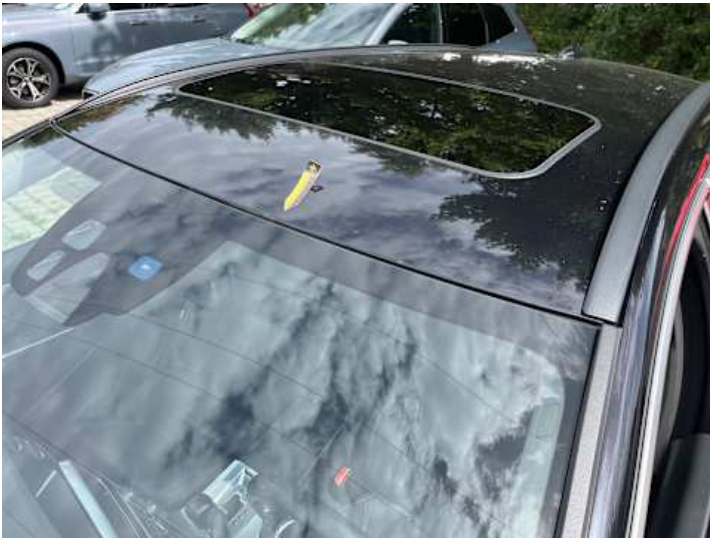
Dach (Lackschaden, Rost)
