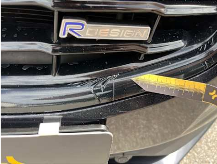
Stoßstange vorne (Unsachgemäß instand gesetzt)
