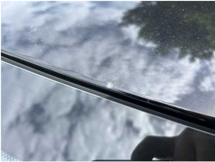
Dach (Lackschaden, Rost)
