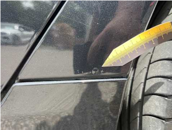
Seitenteil hinten links (Lackschaden, Rost)
