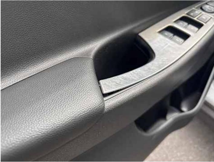
Innenraum (Anderer Schaden): Türgriffschale gebrochen
