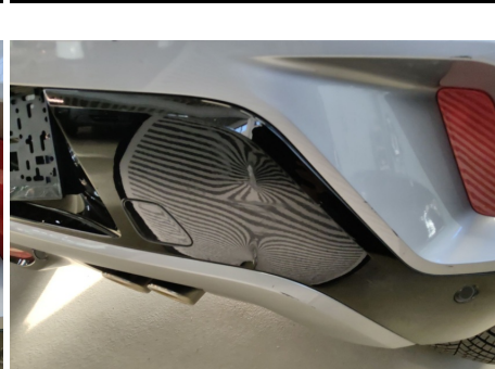
Stoßfängerleiste / Hinten / Gebrochen
