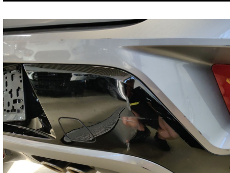
Stoßfängerleiste / Hinten / Gebrochen
