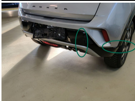
Stoßfängerleiste / Hinten / Gebrochen
