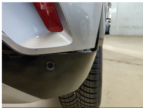
Stoßfängerleiste / Hinten / Gebrochen
