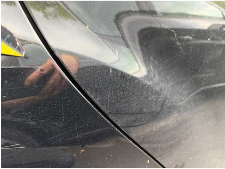
Türe hinten rechts (Lackschaden, Kratzer)
