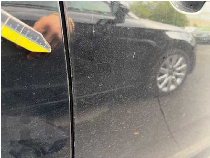
Beifahrertür (Lackschaden, Kratzer)
