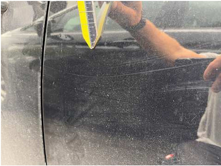
Türe hinten links (Lackschaden, Kratzer)
