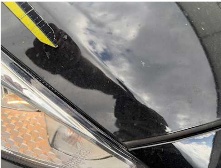
Motorhaube (Lackschaden, Kratzer)
