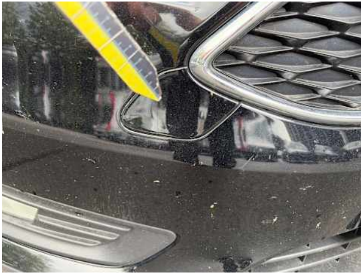
Stoßstange vorne (Kratzer, Lackschaden)
