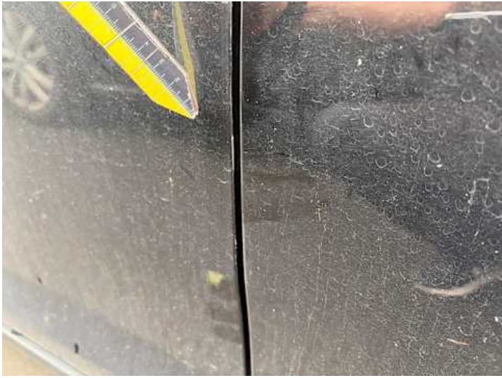
Fahrtür (Lackschaden, Kratzer)
