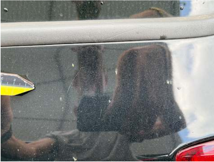
Seitenteil hinten links (Lackschaden, Kratzer)
