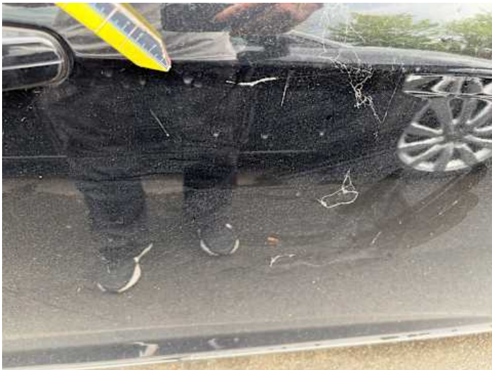
Beifahrertür (Lackschaden, Kratzer)
