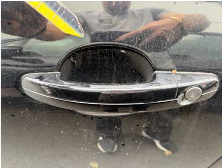
Fahrrertür (Lackschaden, Kratzer)
