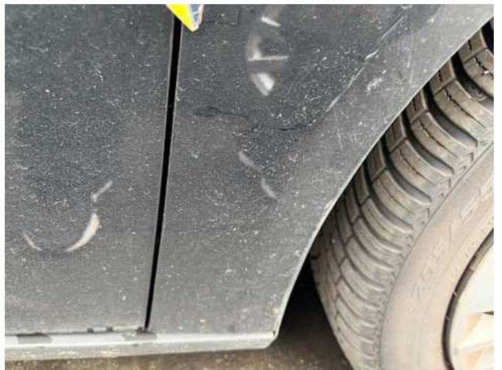
Kotflügel vorne rechts (Lackschaden, Kratzer)
