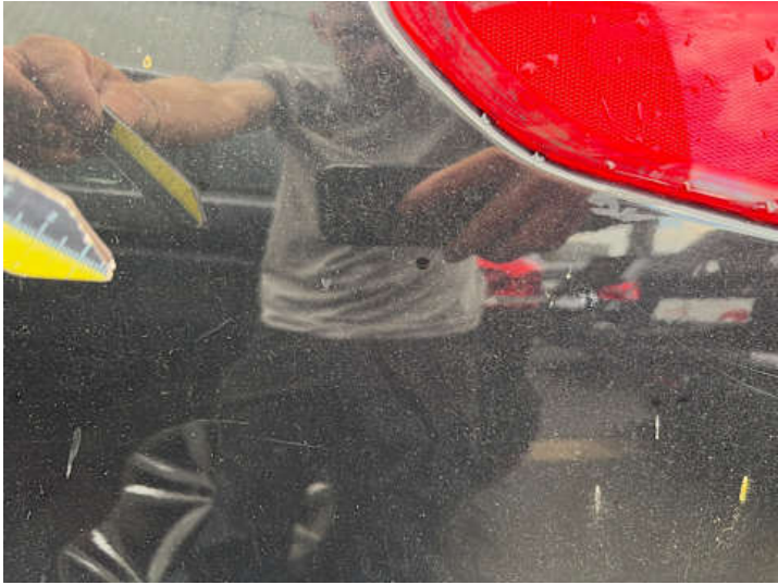
Seitenteil hinten links (Lackschaden, Kratzer)
