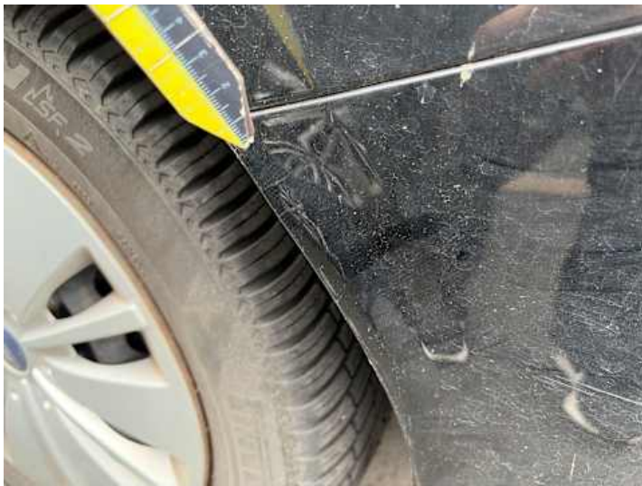
Stoßstange hinten (Lackschaden, Kratzer, Riss/Bruch)
