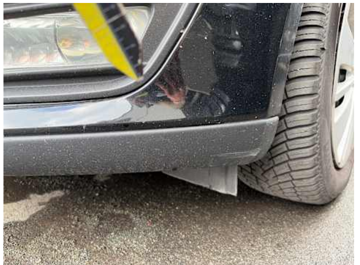
Stoßstange vorne (Kratzer, Lackschaden)
