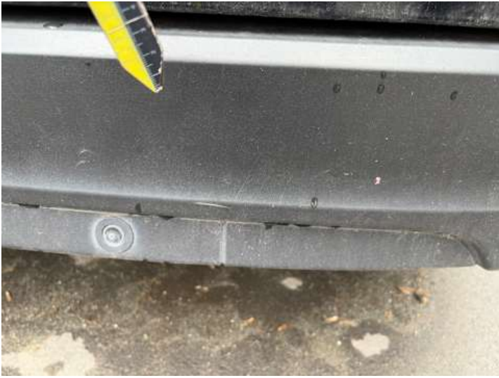
Stoßstange hinten (Lackschaden, Kratzer)
