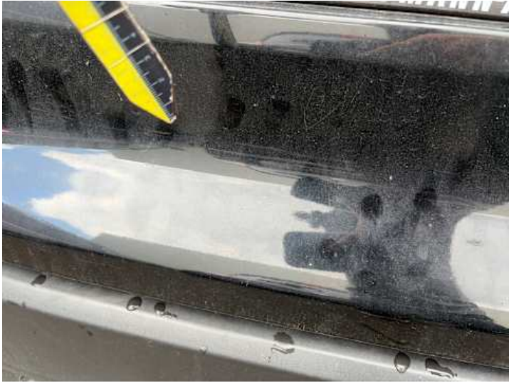
Heckklappe (Lackschaden, Kratzer)
