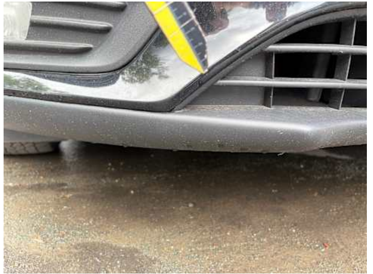
Stoßstange vorne (Kratzer, Lackschaden)
