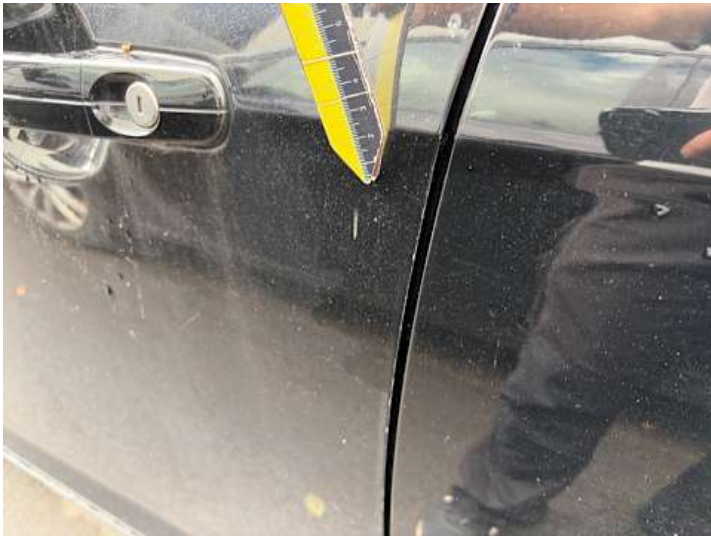
Fahrrertür (Lackschaden, Kratzer)
