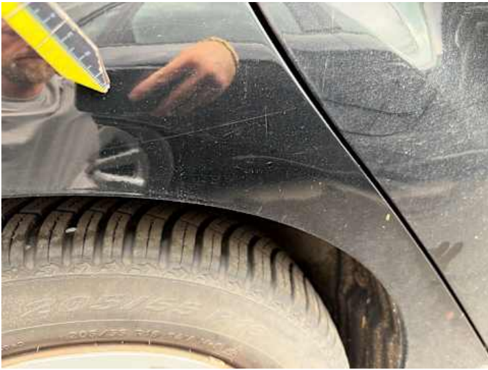
Seitenteil hinten rechts (Lackschaden, Kratzer)
