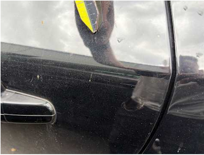
Türe hinten links (Lackschaden, Kratzer)
