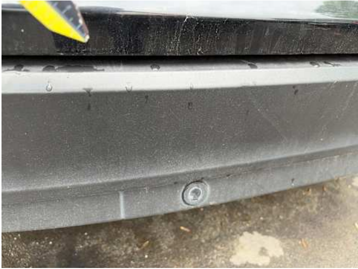
Stoßstange hinten (Lackschaden, Kratzer)
