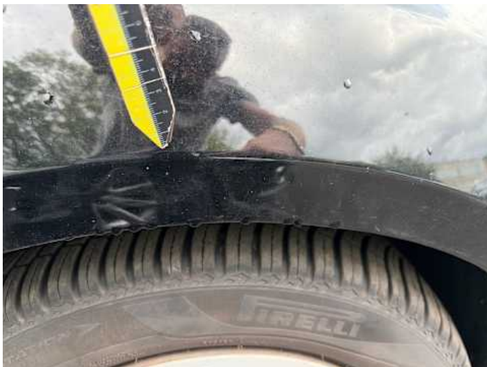
Kotflügel vorne rechts (Lackschaden, Kratzer)
