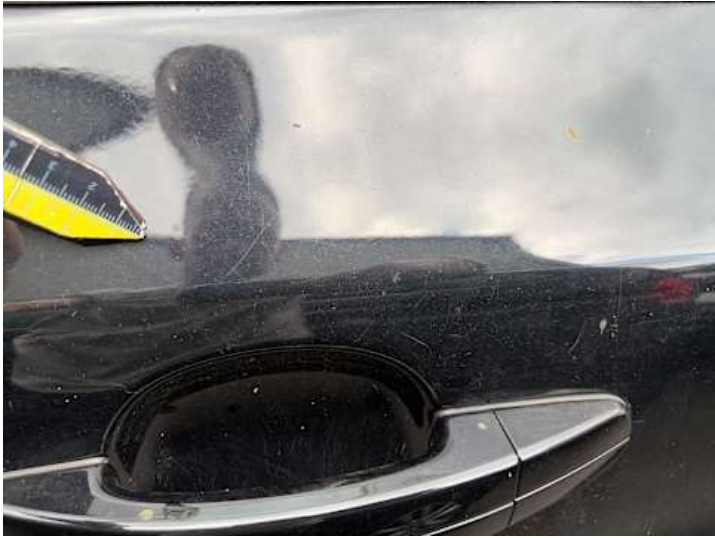
Türe hinten links (Lackschaden, Kratzer)
