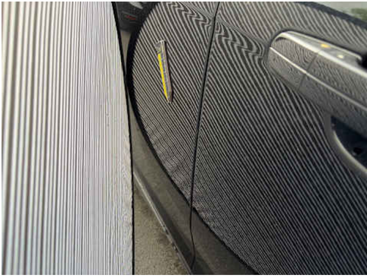
Türe hinten rechts (Delle)
