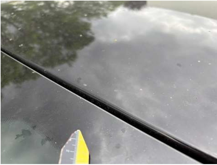
Dach (Lackschaden, Steinschlag, Kratzer)
