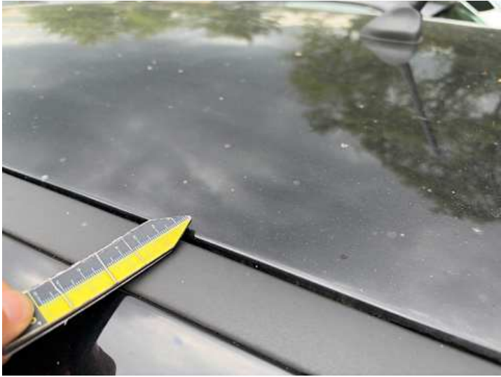
Dach (Lackschaden, Steinschlag, Kratzer)
