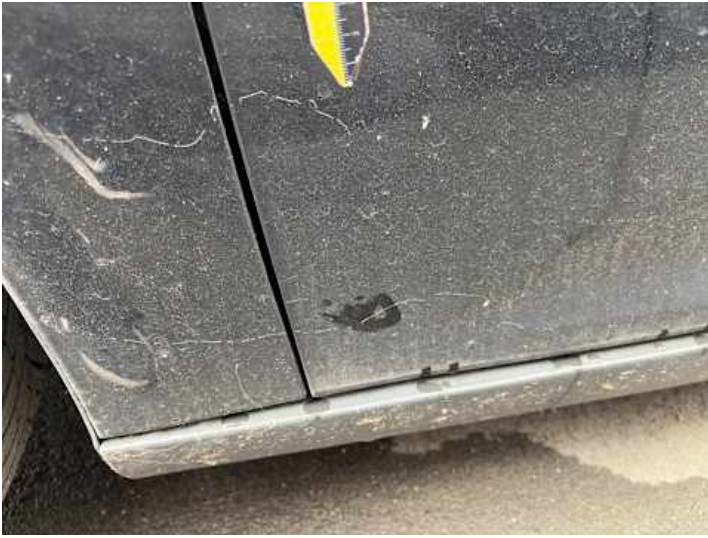
Fahrtür (Lackschaden, Kratzer)
