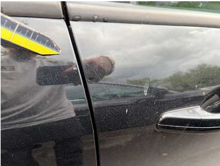
Beifahrertür (Lackschaden, Kratzer)
