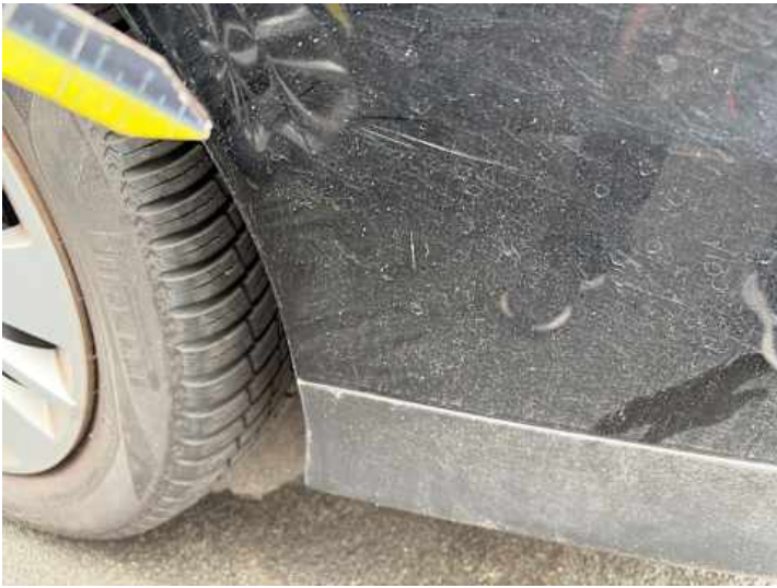
Stoßstange hinten (Lackschaden, Kratzer)
