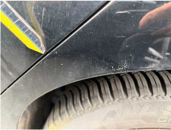
Seitenteil hinten links (Lackschaden, Kratzer)
