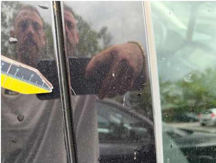
Beifahrertür (Lackschaden, Kratzer)
