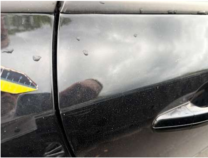
Türe hinten rechts (Lackschaden, Kratzer)
