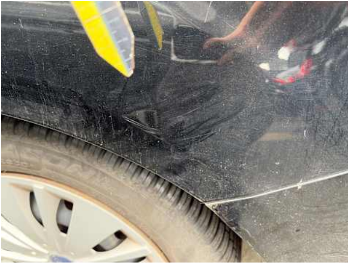
Seitenteil hinten links (Lackschaden, Kratzer)
