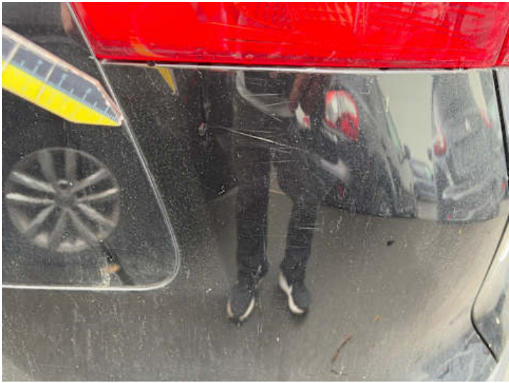
Stoßstange hinten (Lackschaden, Kratzer)
