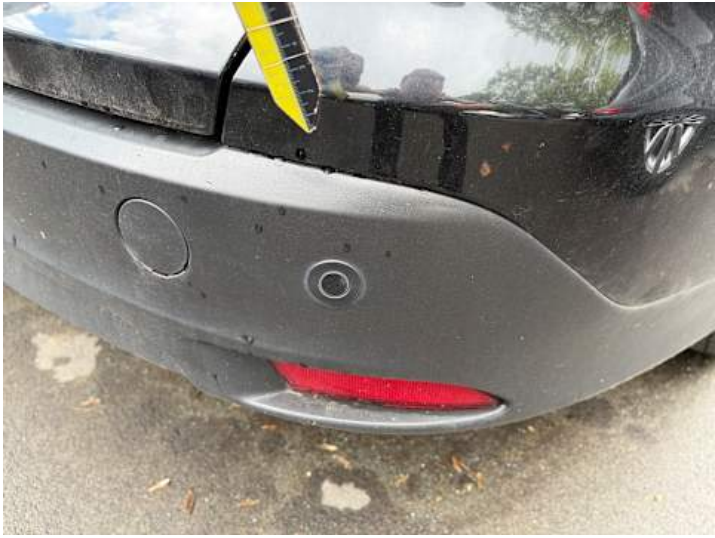
Stoßstange hinten (Lackschaden, Kratzer)
