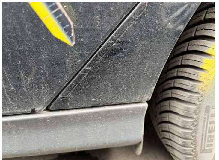
Seitenteil hinten links (Lackschaden, Kratzer)
