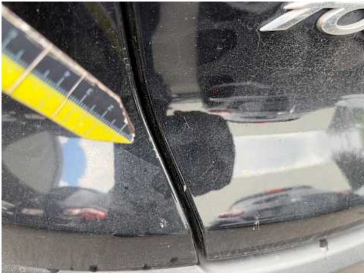
Heckklappe (Lackschaden, Kratzer)
