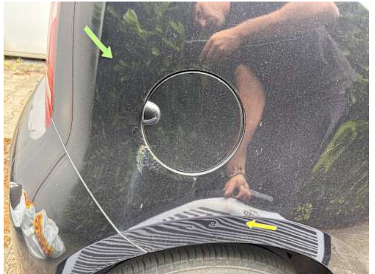
Seitenteil hinten rechts (Lackschaden, Delle, Riss/Bruch)
