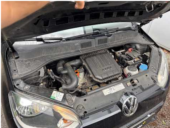
Motorhaube (Anderer Schaden): Haubenaufsteller nicht vorhanden
