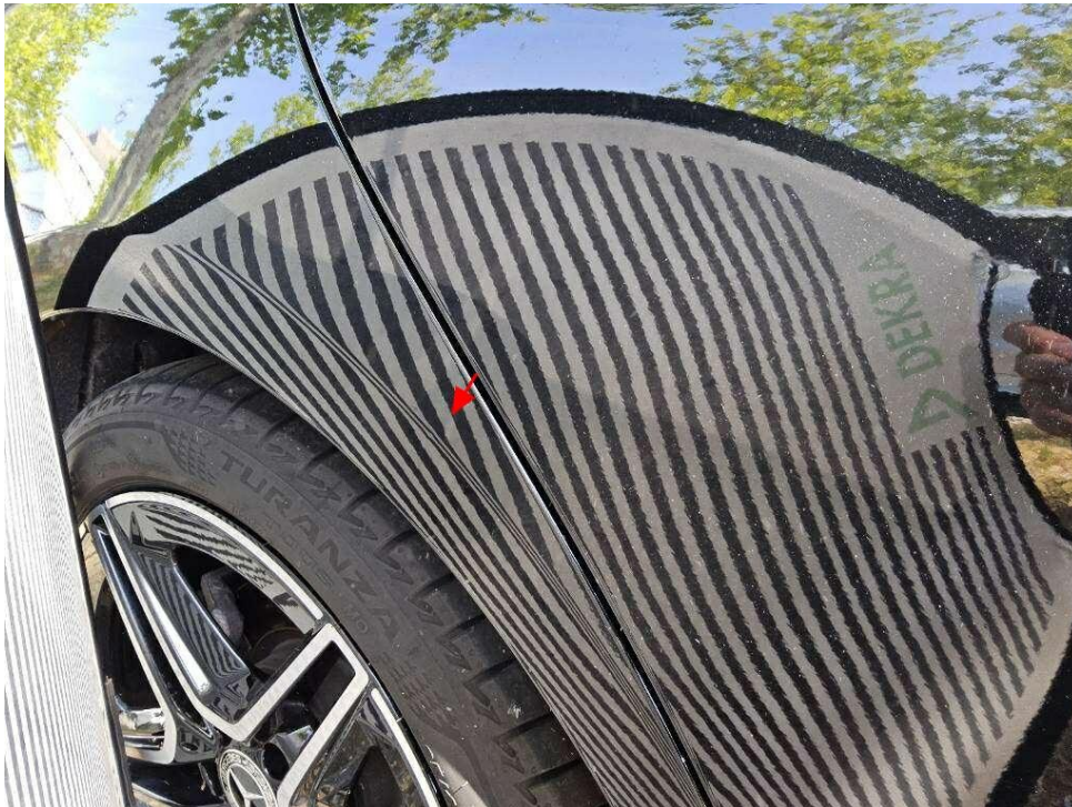
Bild 25 : Seitenteil hinten rechts, eingedellt
