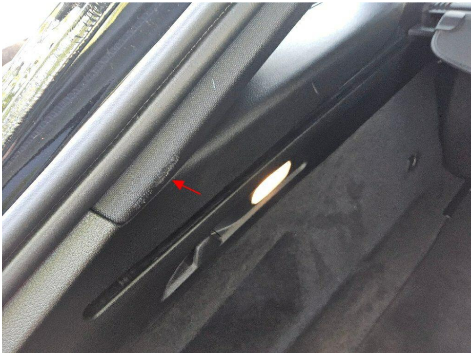
Bild 18 : C-Säulenverkleidung links verschrammt
