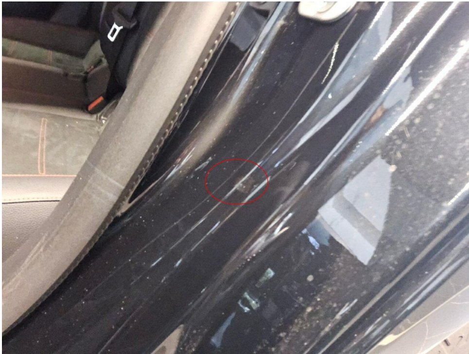
Bild 33 : Einstieg hinten links, ausgebesserte Stelle
