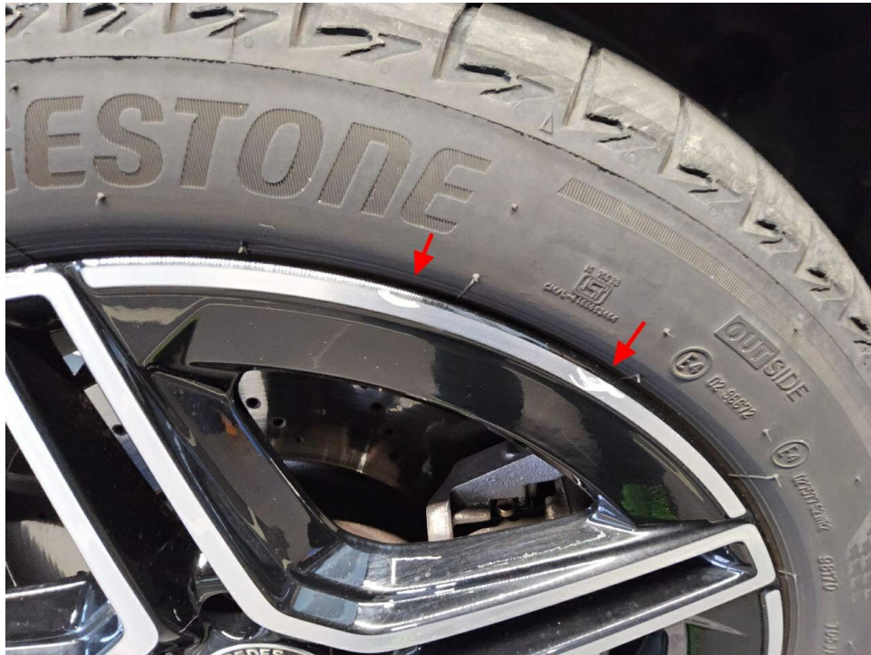
Bild 23 : LM Rad vorne rechts Kratzer
