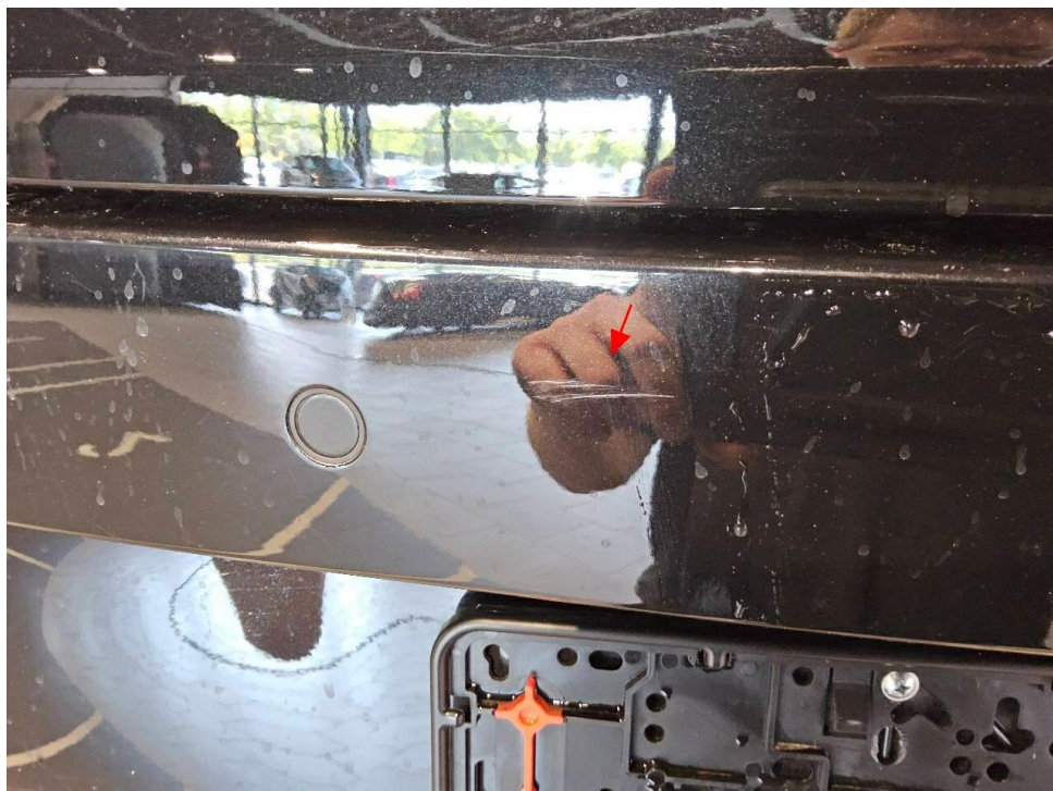
Bild 28 : Stoßfänger hinten Lackierung, zerkratzt
