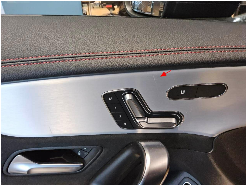
Bild 17 : Türverkleidung vorne links, Zierleiste Kratzer
