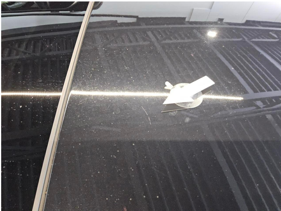
Bild 40 : Dach Lackierung, zerkratzt
