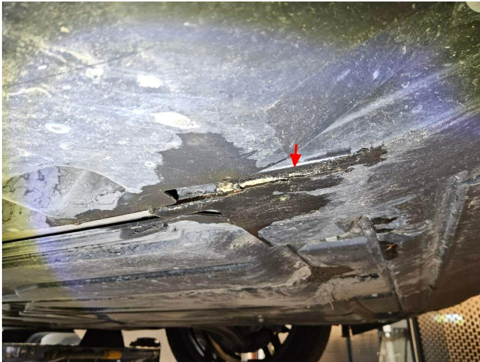
Bild 19 : Unterbodenverkleidung hinter Stoßfänger vorne gebrochen
