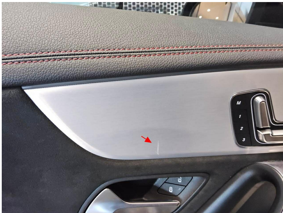
Bild 16 : Türverkleidung vorne links, Zierleiste Kratzer
