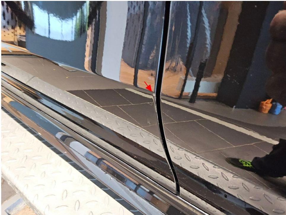
Bild 35 : Tür vorne links Türkante, zerkratzt
