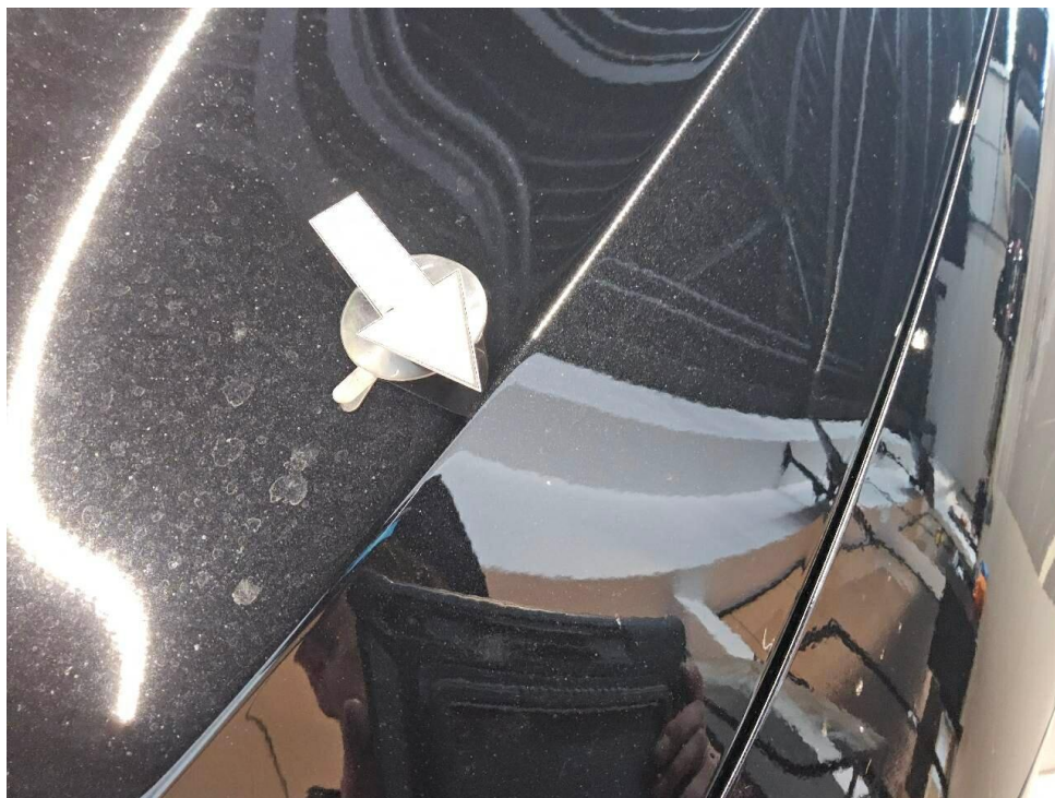
Bild 22 : Motorhaube Lackierung, Steinschlag
