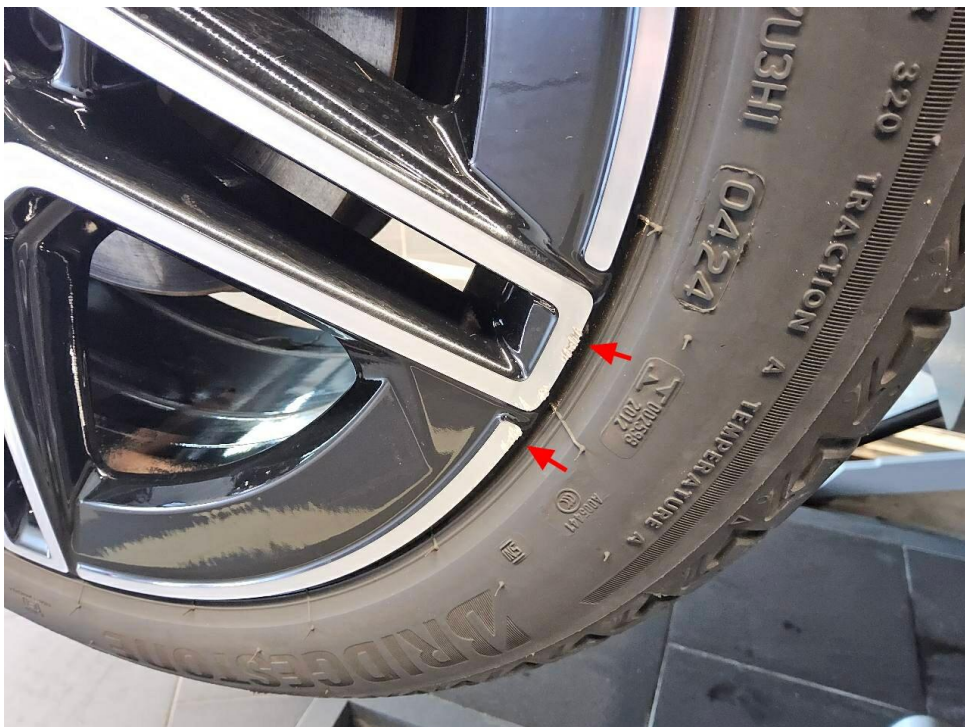
Bild 26 : LM Rad hinten rechts Schrammen
