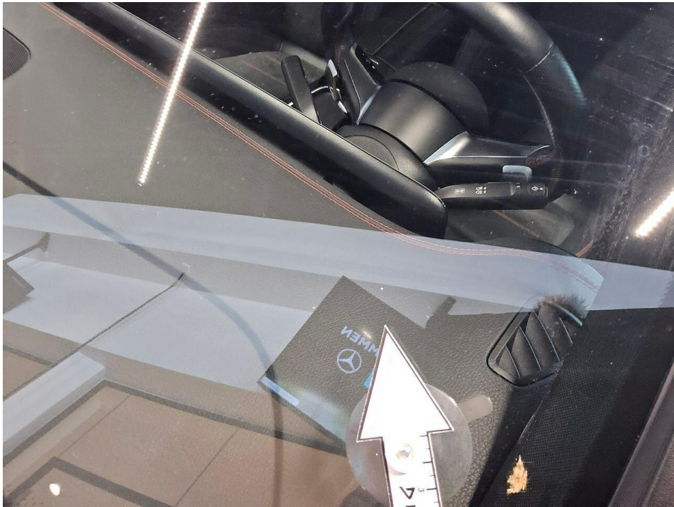
Bild 39 : Frontscheibe, Steinschlag, Gebrauchsspur
