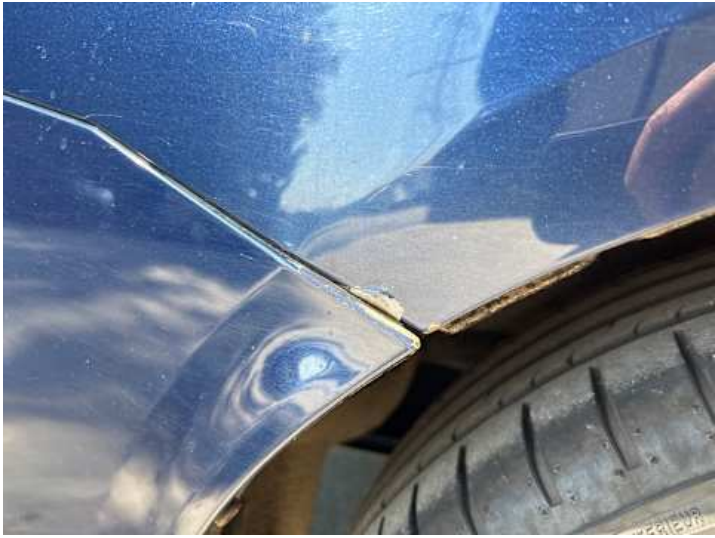
Seitenteil hinten rechts (Kratzer, Lackschaden, Rost)
