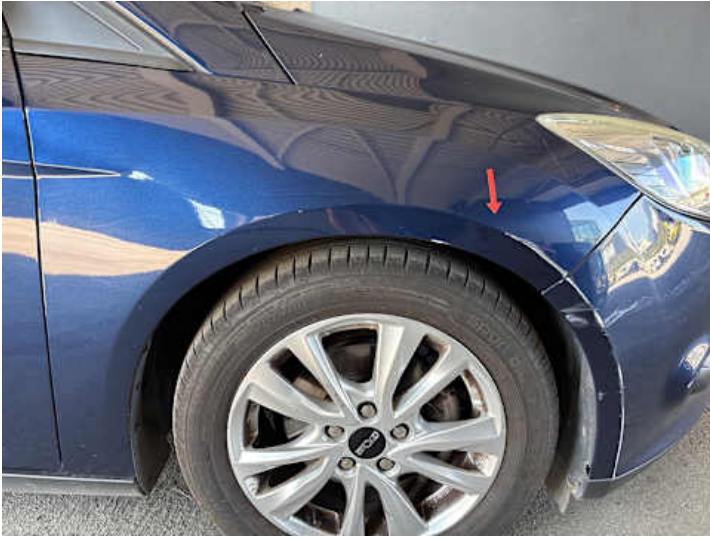
Kotflügel vorne rechts (Kratzer, Lackschaden)
