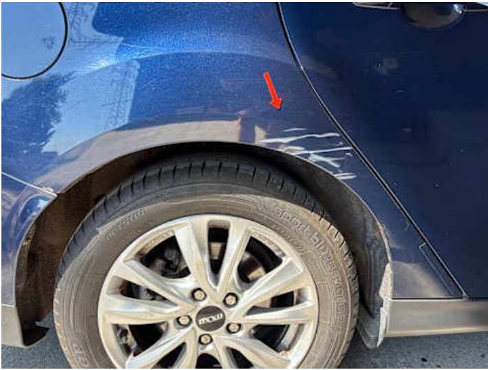
Seitenteil hinten rechts (Kratzer, Lackschaden, Rost)
