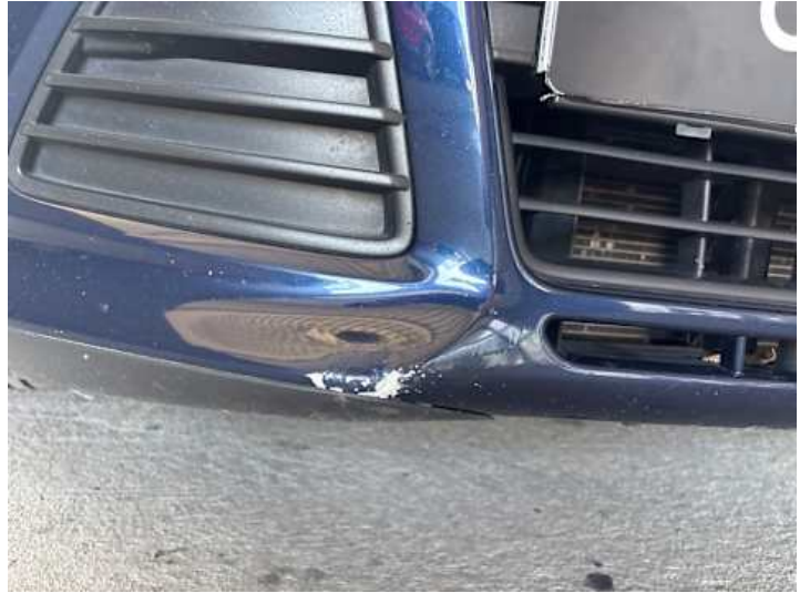
Stoßstange vorne (Steinschlag, Kratzer, Lackschaden)
