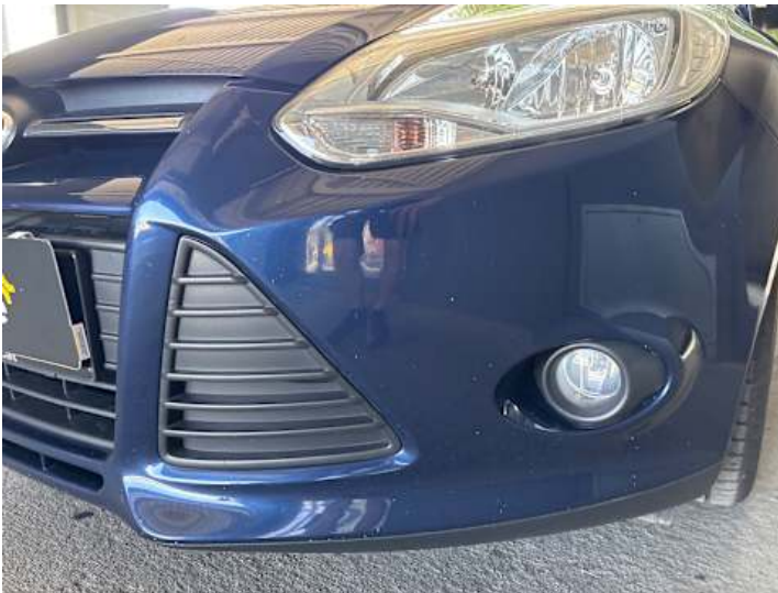
Stoßstange vorne (Steinschlag, Kratzer, Lackschaden)
