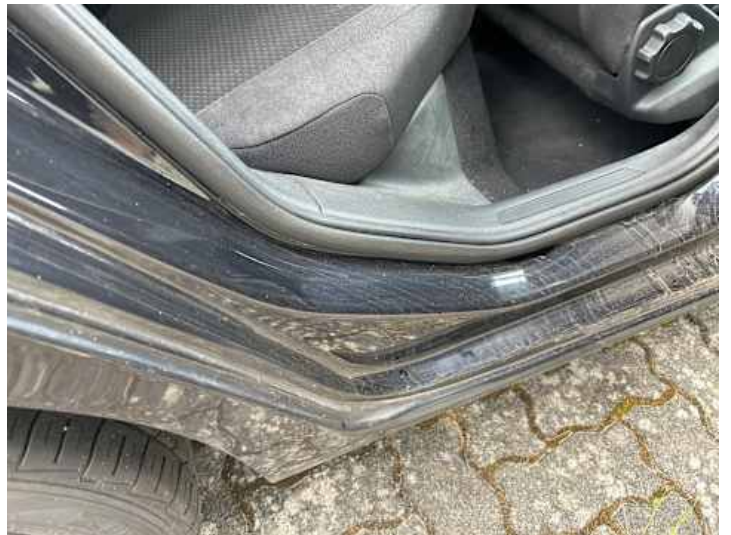
Schweller rechts (Delle, Kratzer)
