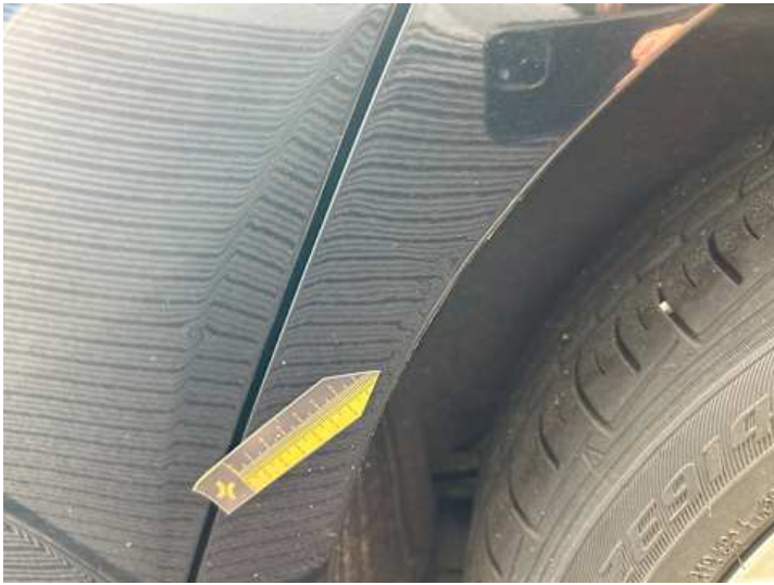
Seitenteil hinten links (Unsachgemäß instand gesetzt)
