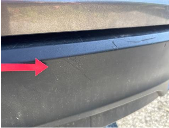
Stoßstange hinten (Kratzer)
