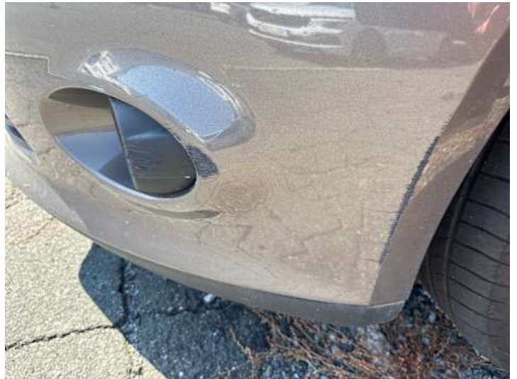
Stoßstange vorne (Kratzer, Lackschaden)
