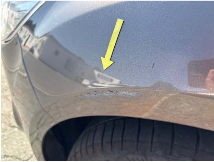
Kotflügel vorne links (Kratzer, Lackschaden)
