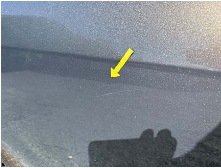
Türe hinten rechts (Kratzer)
