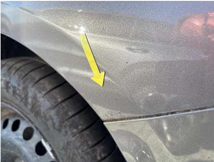
Seitenteil hinten links (Rost)
