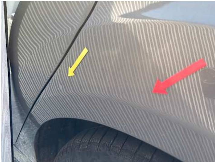
Seitenteil hinten links (Delle)
