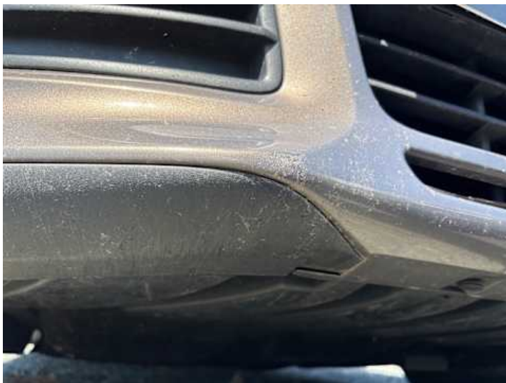
Stoßstange vorne (Kratzer, Lackschaden)
