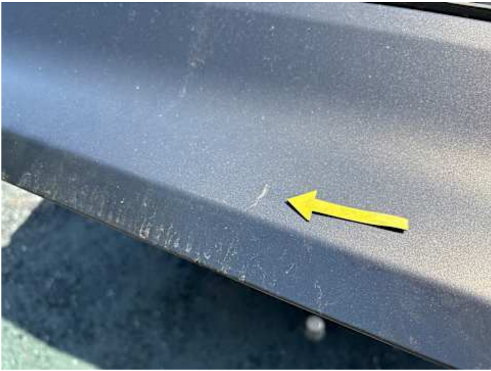
Heckklappe (Kratzer, Lackschaden)
