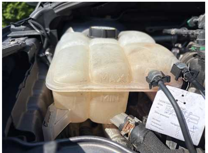
Motorhaube (Anderer Schaden): Kühlmittelbehälter leer
