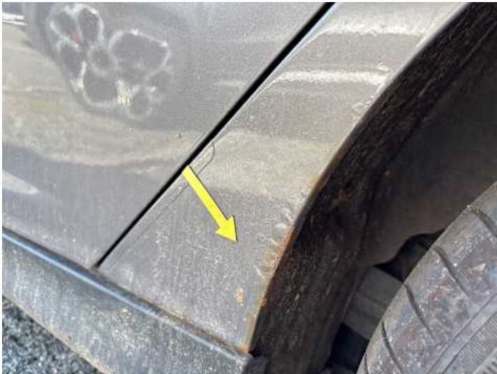
Seitenteil hinten links (Rost)
