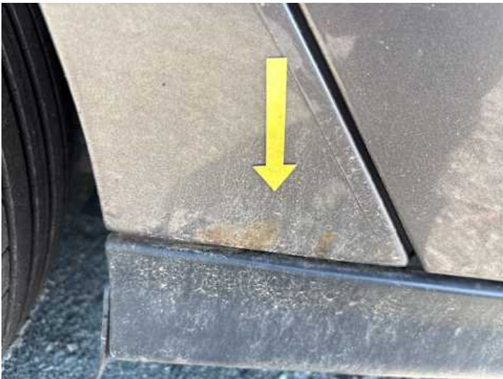
Seitenteil hinten rechts (Rost)
