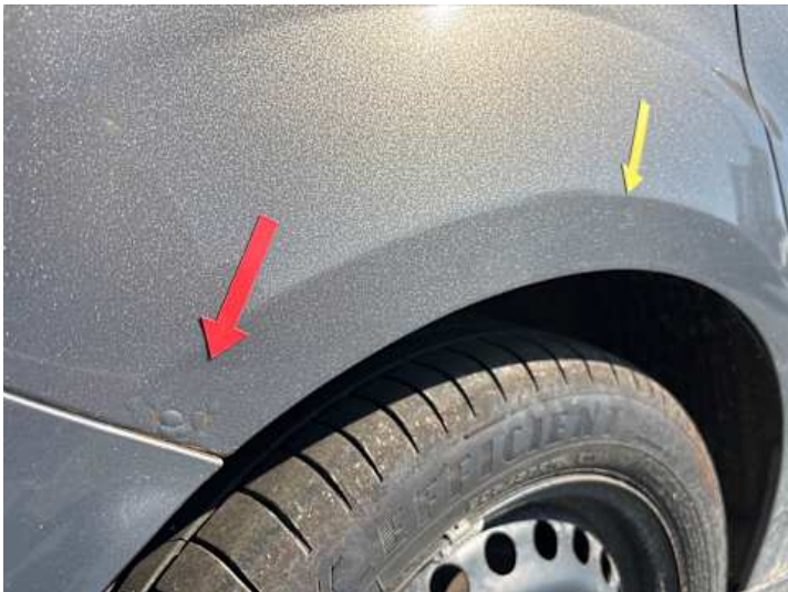
Seitenteil hinten rechts (Rost, Kratzer)
