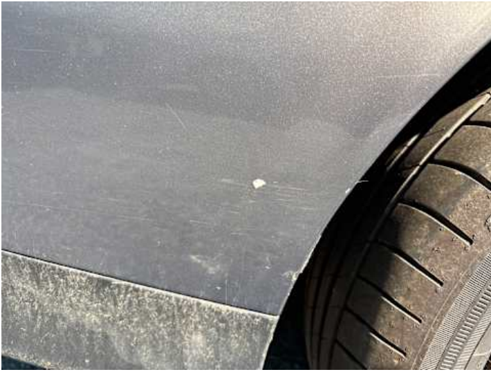
Stoßstange hinten (Lackschaden, Kratzer)
