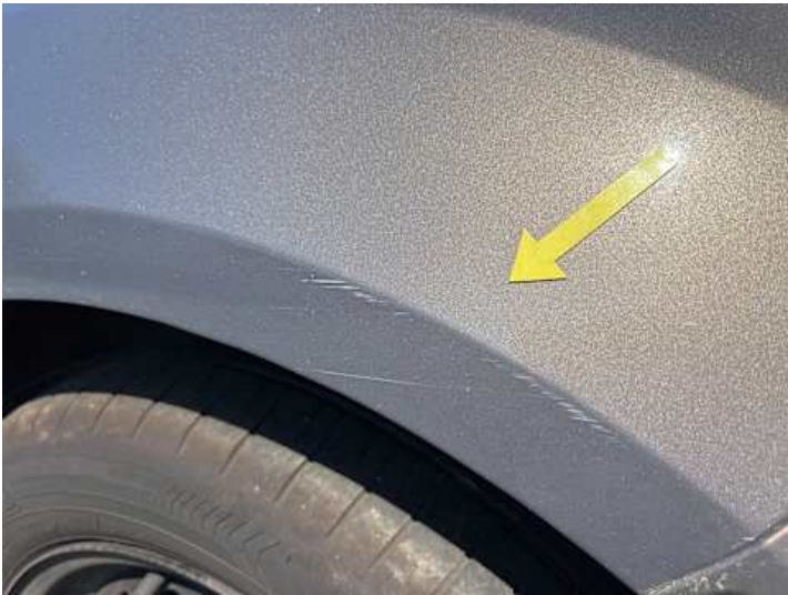
Kotflügel vorne rechts (Kratzer)
