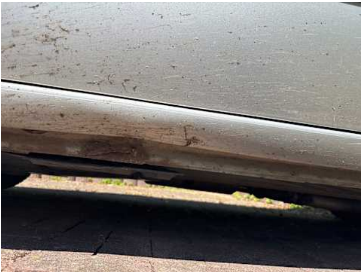
Schweller links (Verformung)
