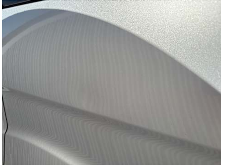
Seitenteil hinten links (Delle)
