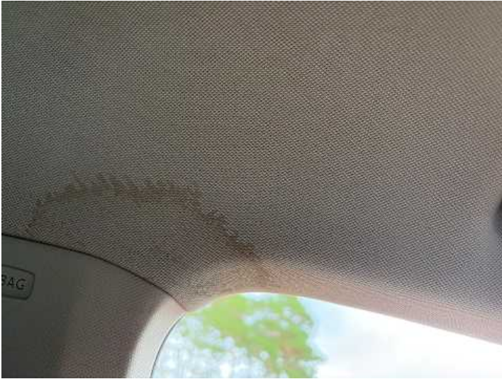
Innenraum (Riss/Bruch, Verschmutzung, Wassereintritt)
