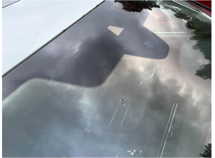
Windschutzscheibe (Riss/Bruch, Steinschlag)
