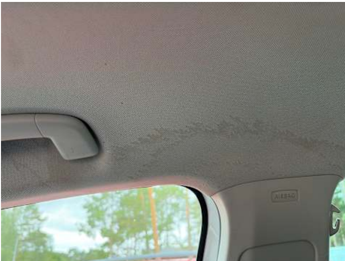
Innenraum (Riss/Bruch, Verschmutzung, Wassereintritt)
