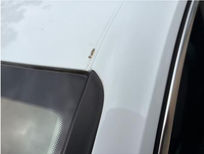
Dach (Lackschaden, Rost)
