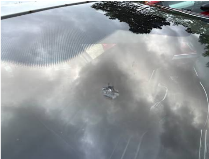
Windschutzscheibe (Riss/Bruch, Steinschlag)
