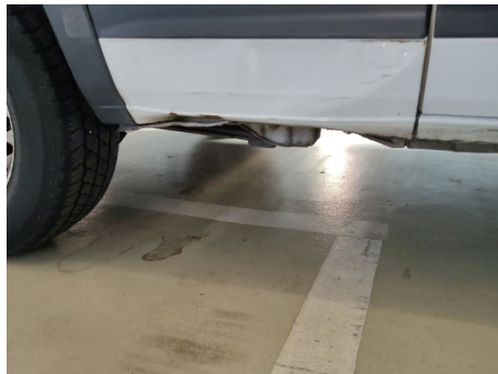
Schweller / Hinten Rechts / Delle
