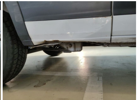
Schweller / Hinten Rechts / Delle
