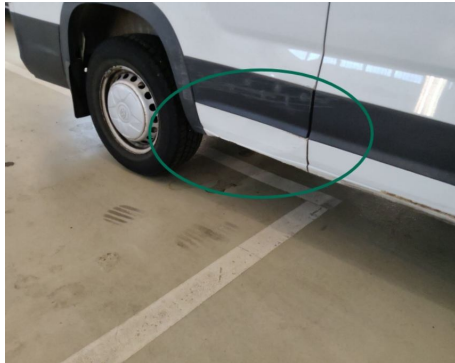
Schweller / Hinten Rechts / Delle
