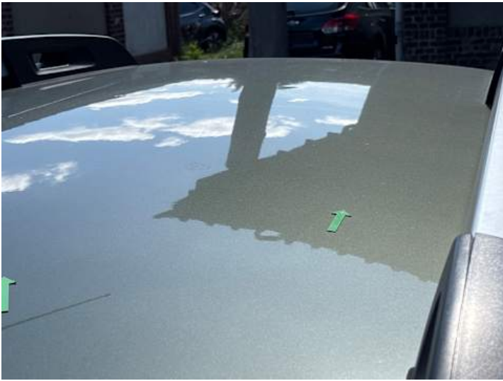
Dach (Delle, Anderer Schaden): Hagelschaden
