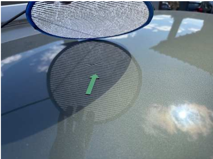
Dach (Delle, Anderer Schaden): Hagelschaden
