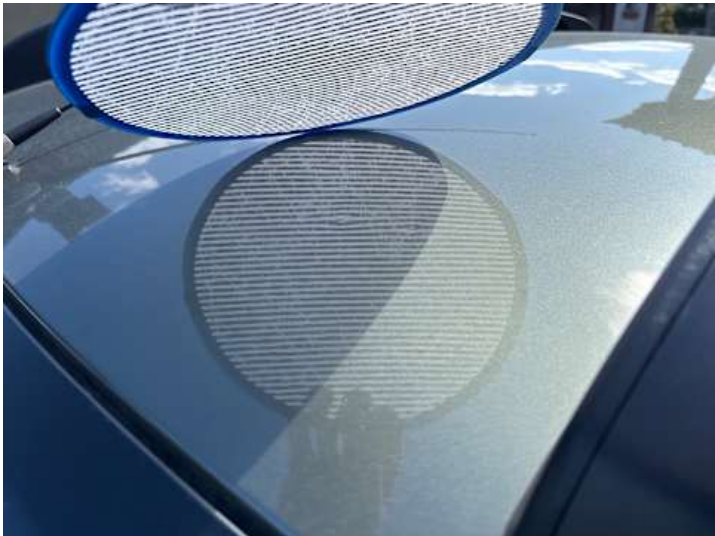
Dach (Delle, Anderer Schaden): Hagelschaden
