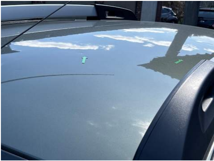
Dach (Delle, Anderer Schaden): Hagelschaden
