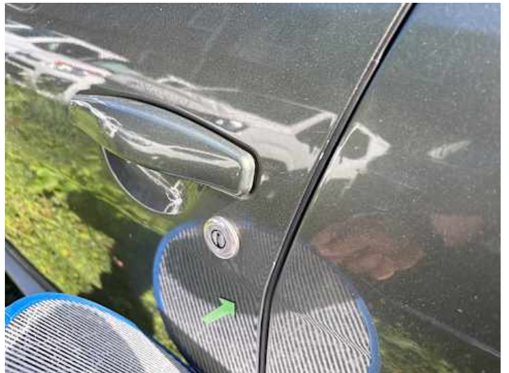
Fahrtür (Kratzer, Delle)
