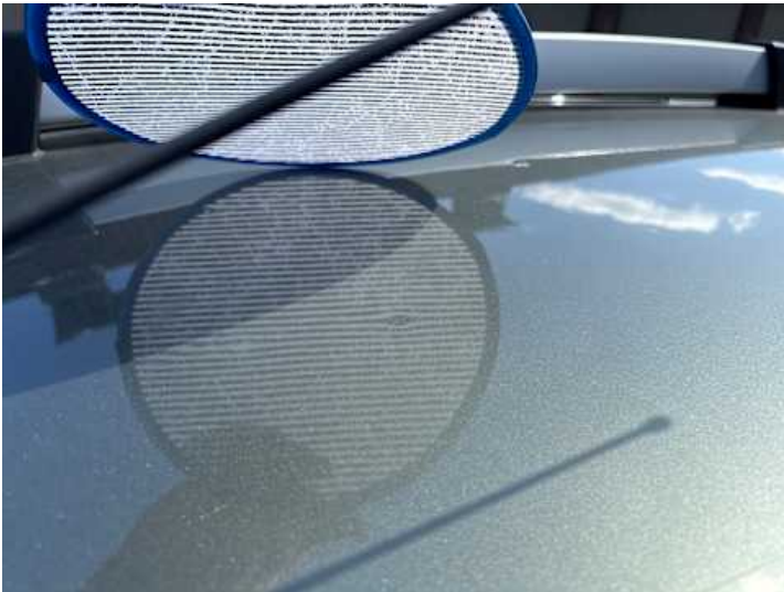
Dach (Delle, Anderer Schaden): Hagelschaden
