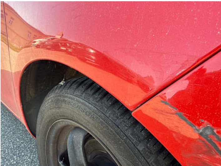
Seitenteil hinten links (Kratzer, Verformung)
