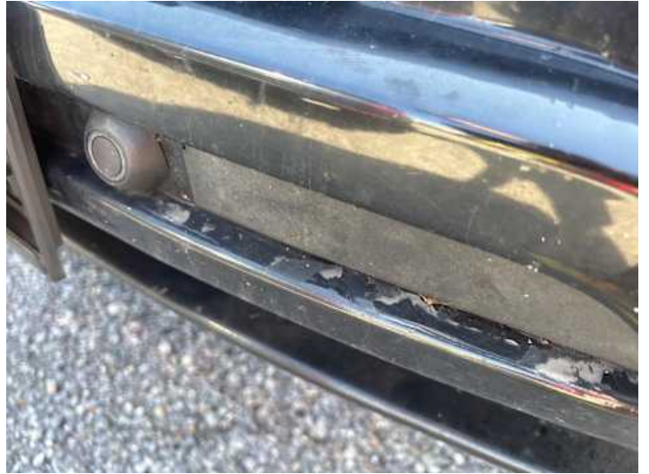
Stoßstange vorne (Unsachgemäß instand gesetzt, Lackschaden)
