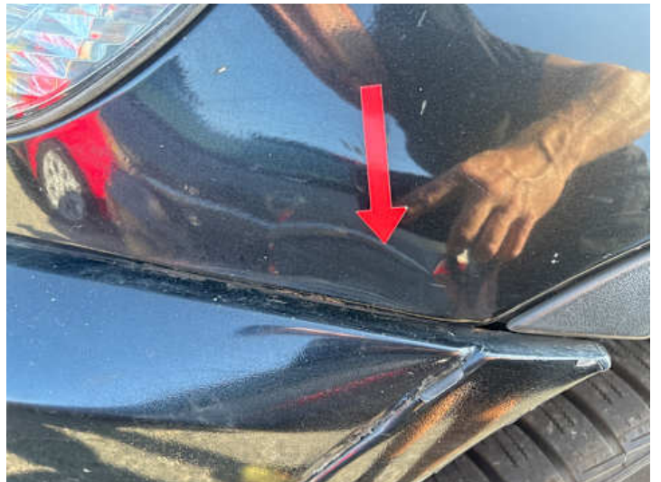
Kotflügel vorne links (Unsachgemäß instand gesetzt)
