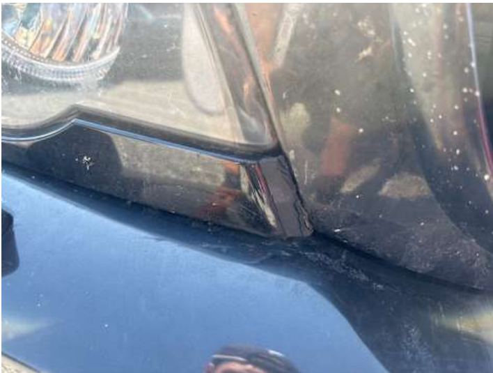
Scheinwerfer (rechts) (Riss/Bruch)
