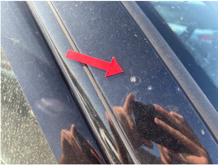
Seitenteil hinten rechts (Steinschlag)
