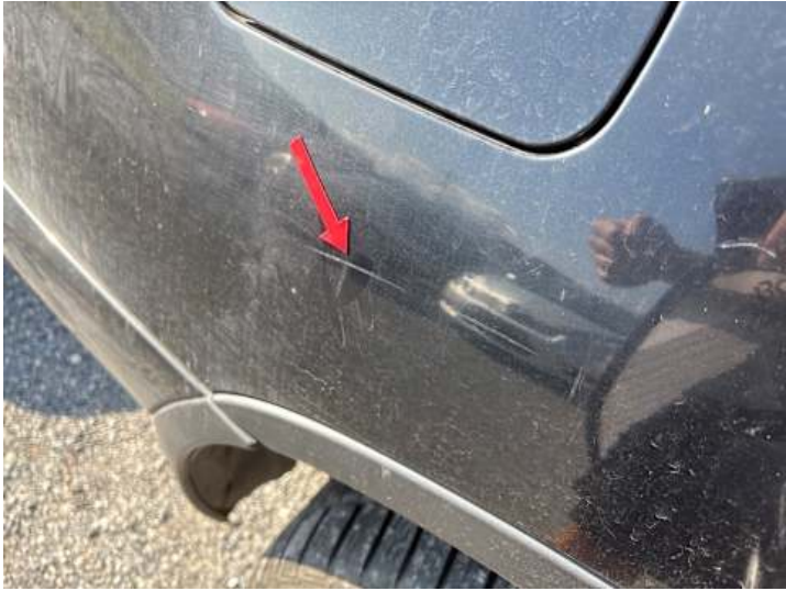
Seitenteil hinten rechts (Kratzer)
