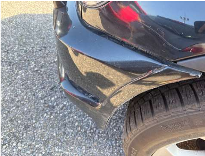
Stoßstange vorne (Unsachgemäß instand gesetzt, Lackschaden)
