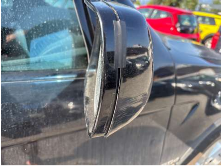
Beifahrtür (Unsachgemäß instand gesetzt, Kratzer)
