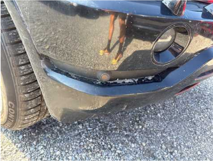
Stoßstange vorne (Unsachgemäß instand gesetzt, Lackschaden)
