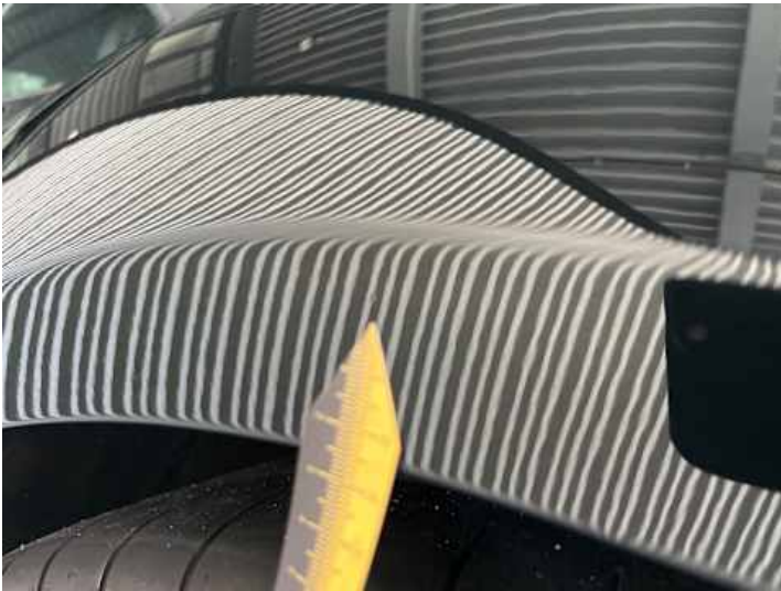
Seitenteil hinten links (Lackschaden, Unsachgemäß instand gesetzt)
