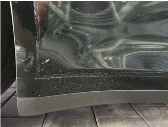
Seitenteil hinten rechts (Steinschlag)
