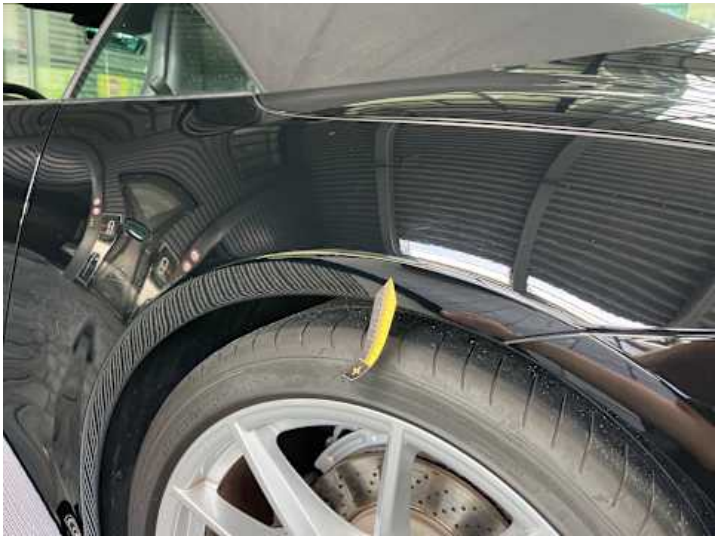
Seitenteil hinten links (Lackschaden, Unsachgemäß instand gesetzt)
