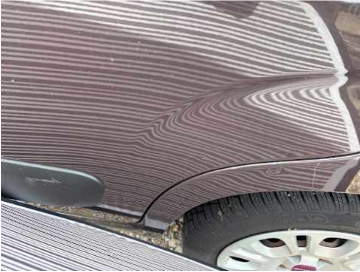
Türe hinten links (Delle)
