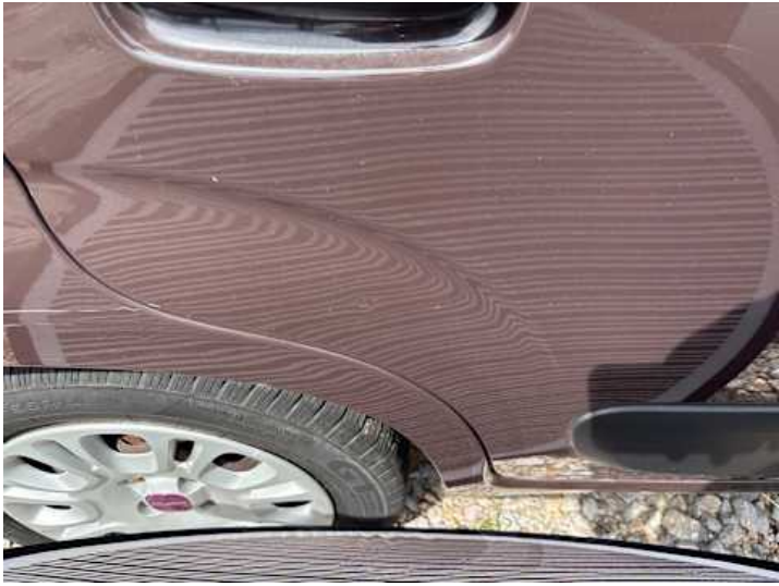
Türe hinten rechts (Delle)
