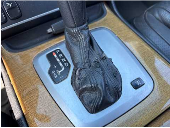
Innenraum (Verschleiß, Riss/Bruch)
