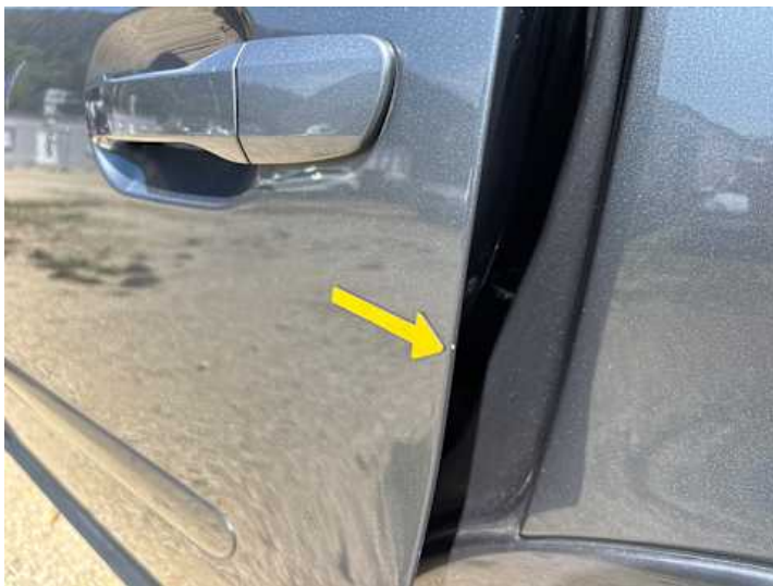
Türe hinten links (Lackschaden, Kratzer)
