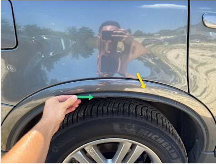
Seitenteil hinten rechts (Kratzer, Lackschaden, Riss/Bruch)
