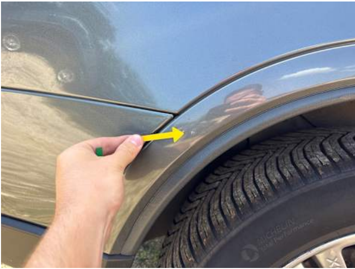
Seitenteil hinten rechts (Kratzer, Lackschaden, Riss/Bruch)
