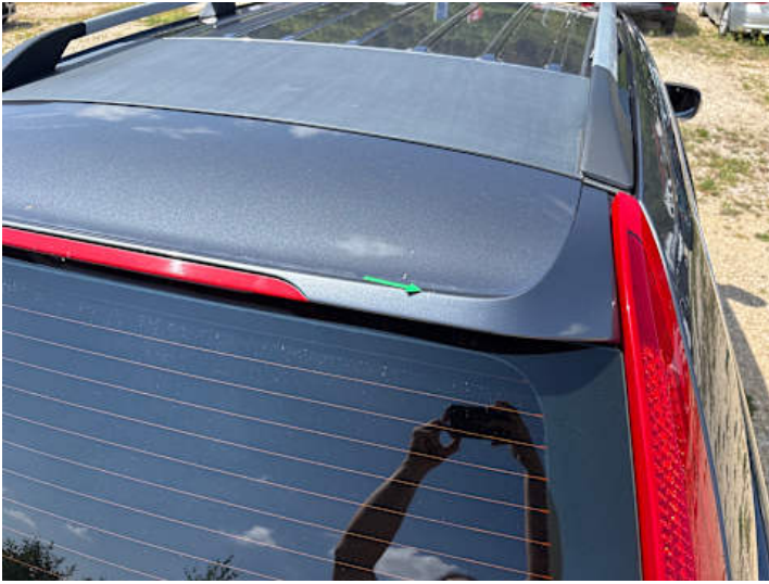
Heckklappe (Kratzer, Lackschaden)
