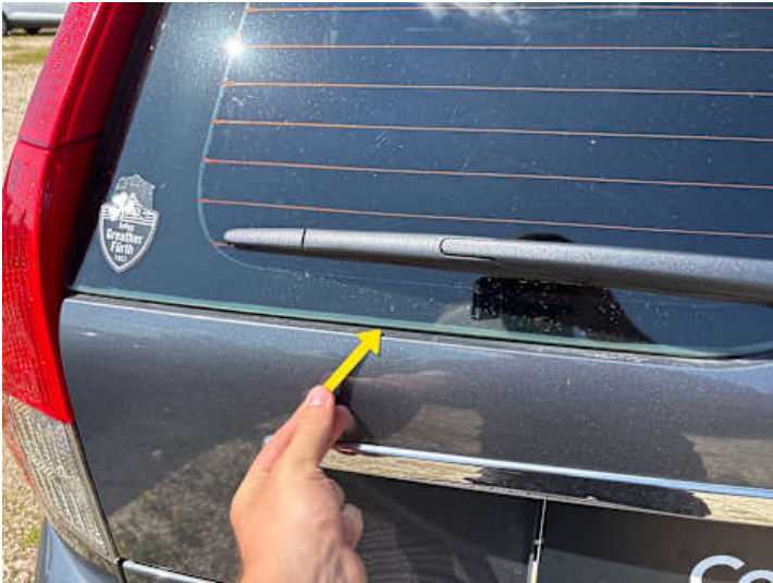
Rückscheibe (Anderer Schaden): Ablösung
