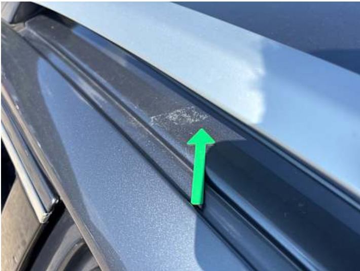
Dach (Kratzer, Lackschaden)
