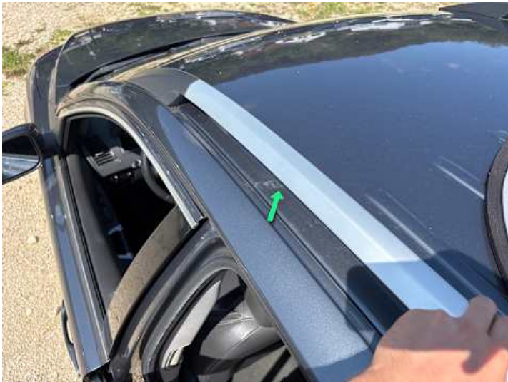
Dach (Kratzer, Lackschaden)
