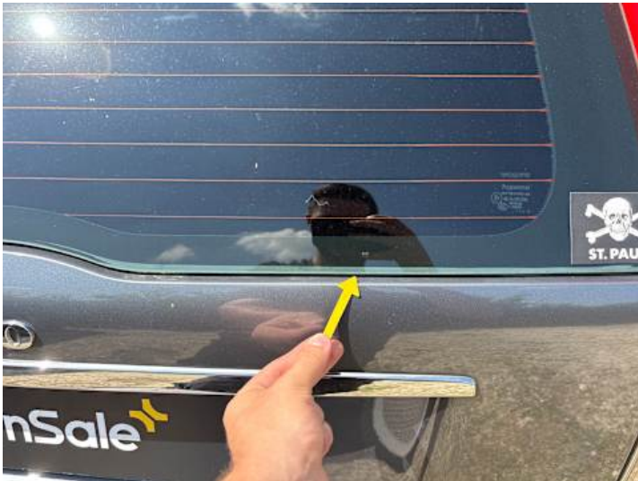
Rückscheibe (Anderer Schaden): Ablösung
