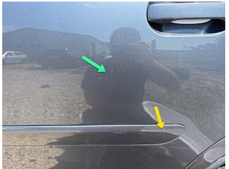
Türe hinten links (Lackschaden, Kratzer)
