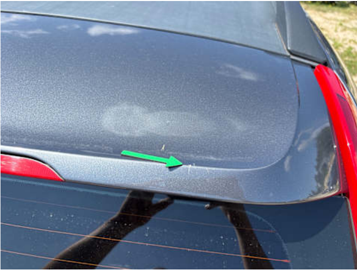
Heckklappe (Kratzer, Lackschaden)
