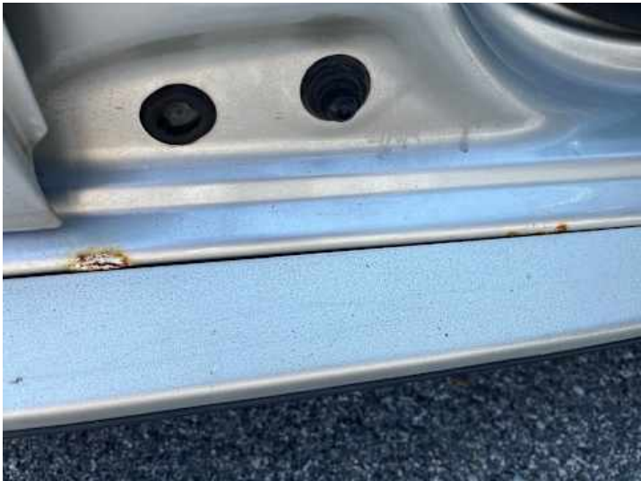
Schweller rechts (Rost)
