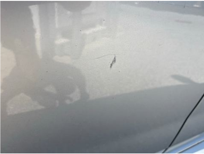
Türe hinten rechts (Delle, Kratzer)
