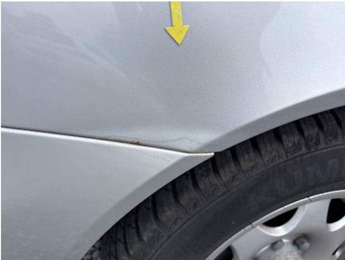
Seitenteil hinten rechts (Lackschaden, Rost)
