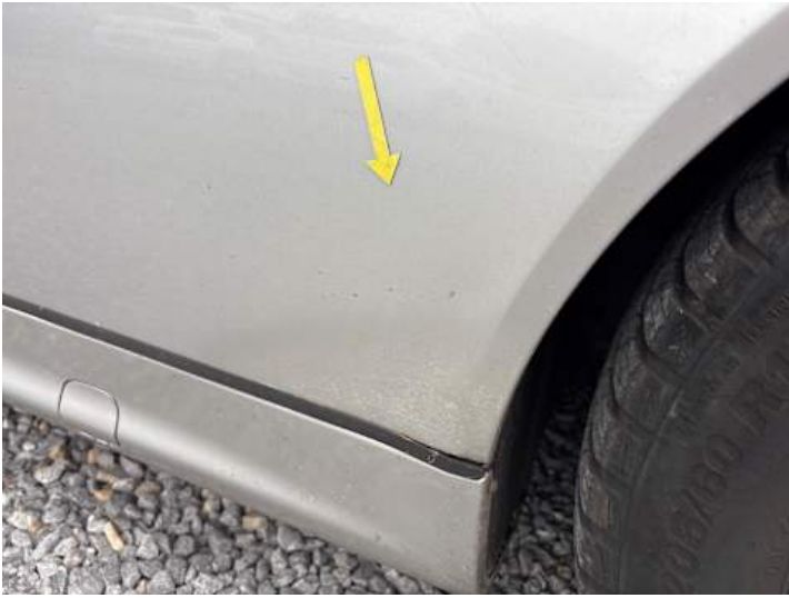
Kotflügel vorne rechts (Lackschaden, Rost)
