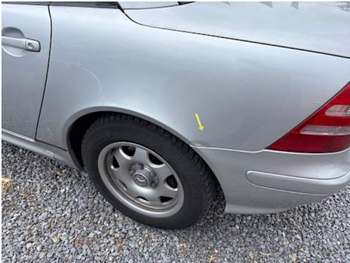
Seitenteil hinten links (Lackschaden, Rost)
