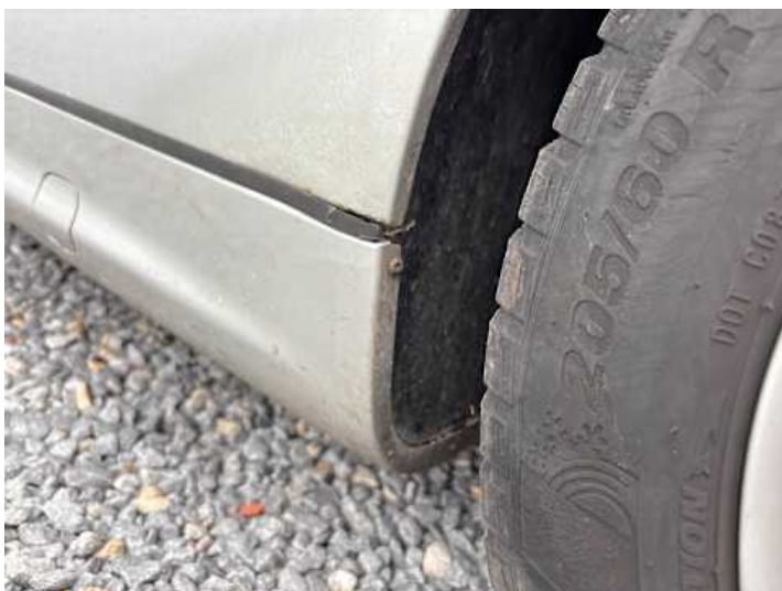
Schweller rechts (Spaltmaße ungenau, Unsachgemäß instand gesetzt)
