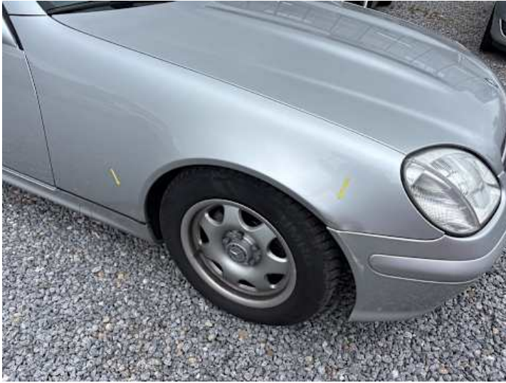
Kotflügel vorne rechts (Lackschaden, Rost, Delle)
