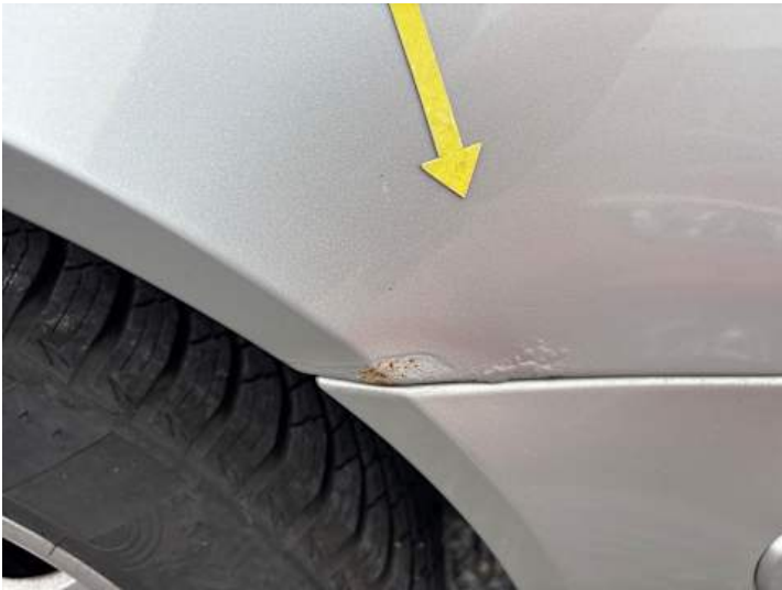
Seitenteil hinten links (Lackschaden, Rost)
