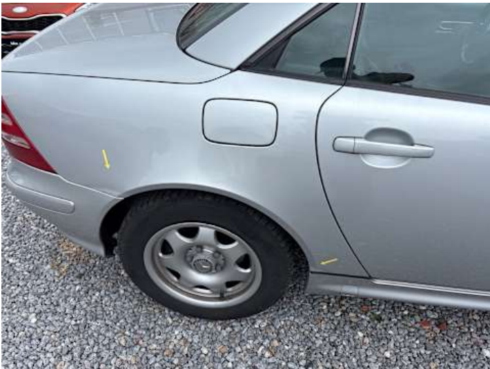
Seitenteil hinten rechts (Lackschaden, Rost)
