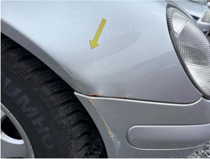
Kotflügel vorne rechts (Lackschaden, Rost, Delle)
