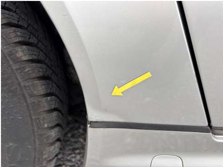
Seitenteil hinten rechts (Lackschaden, Rost)
