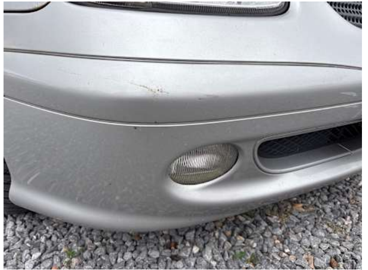
Stoßstange vorne (Kratzer, Lackschaden)
