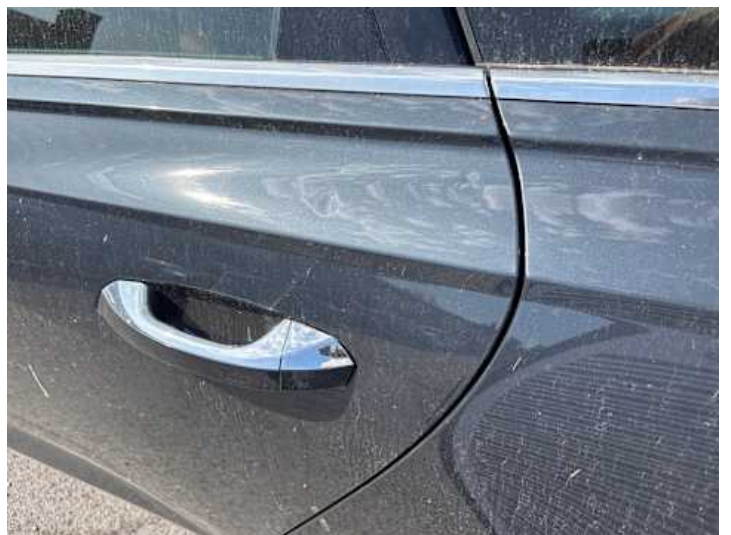
Türe hinten links (Delle)
