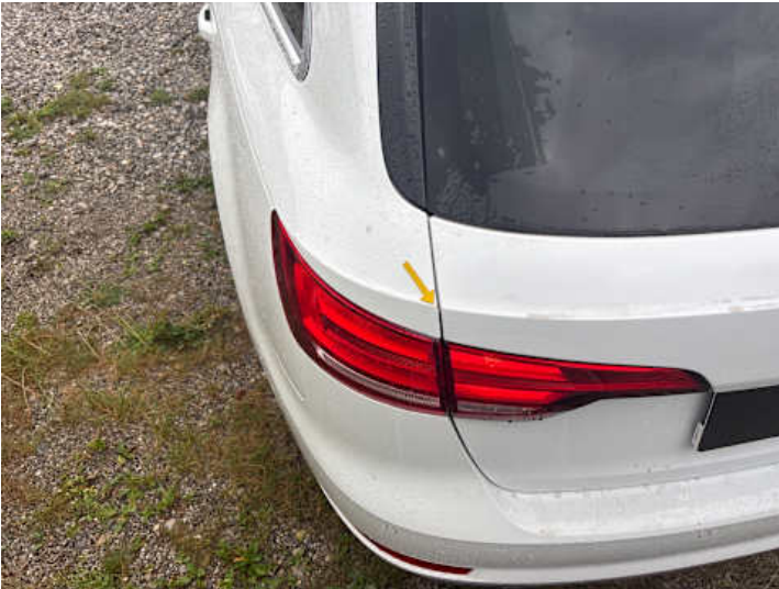
Seitenteil hinten links (Lackschaden, Rost)
