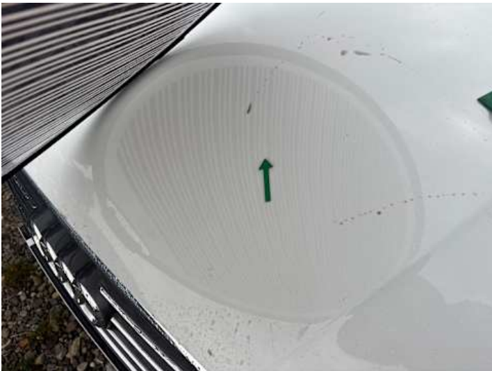
Motorhaube (Kratzer, Delle)
