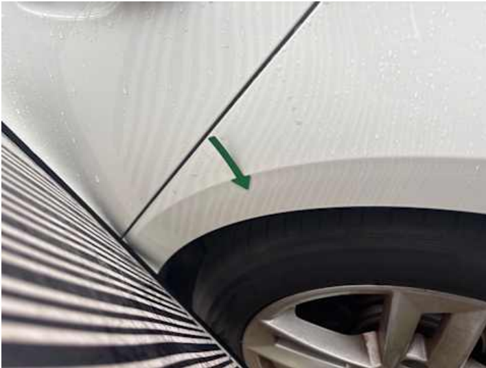
Seitenteil hinten links (Verformung)
