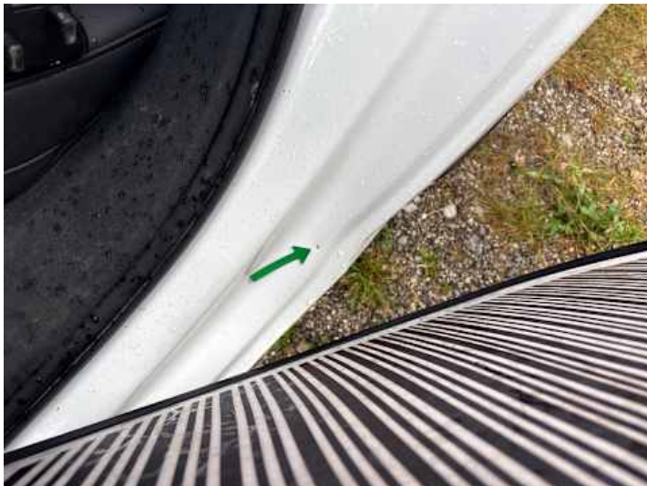
Schweller links (Lackschaden, Delle)
