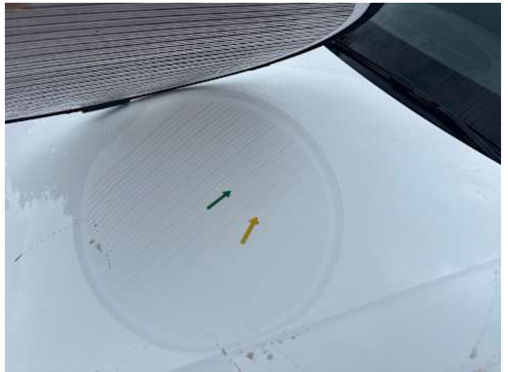
Motorhaube (Kratzer, Delle)
