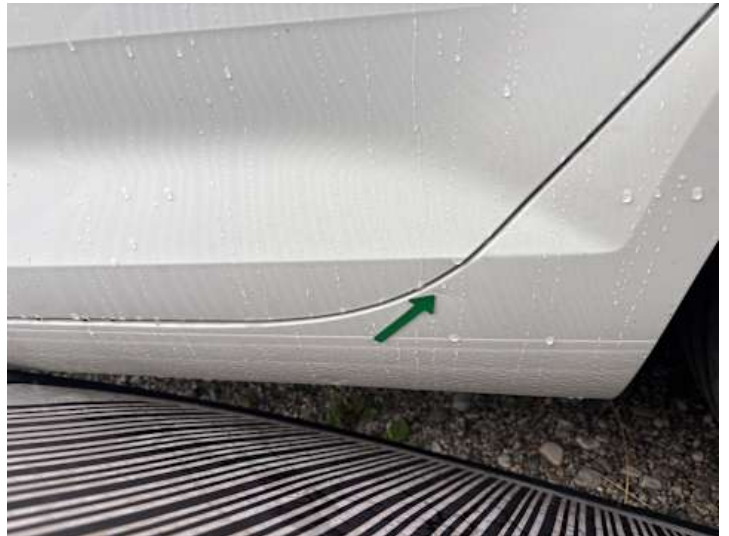
Schweller links (Lackschaden, Delle)
