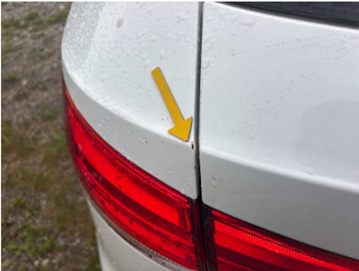
Seitenteil hinten links (Lackschaden, Rost)
