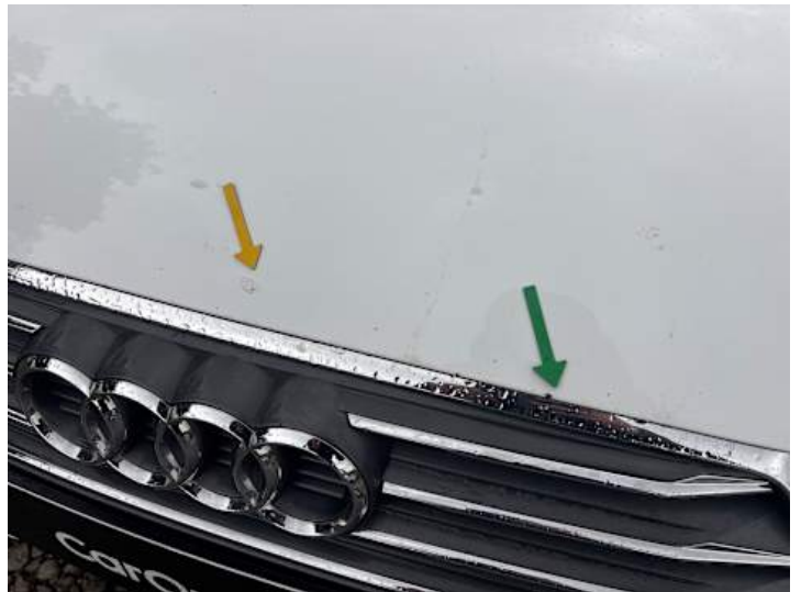
Motorhaube (Lackschaden, Rost, Steinschlag)
