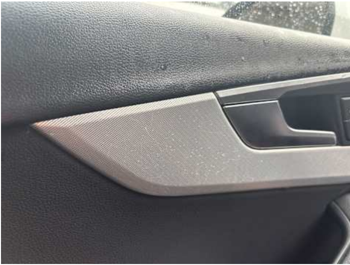
Innenraum (Kratzer, Verschleiß)
