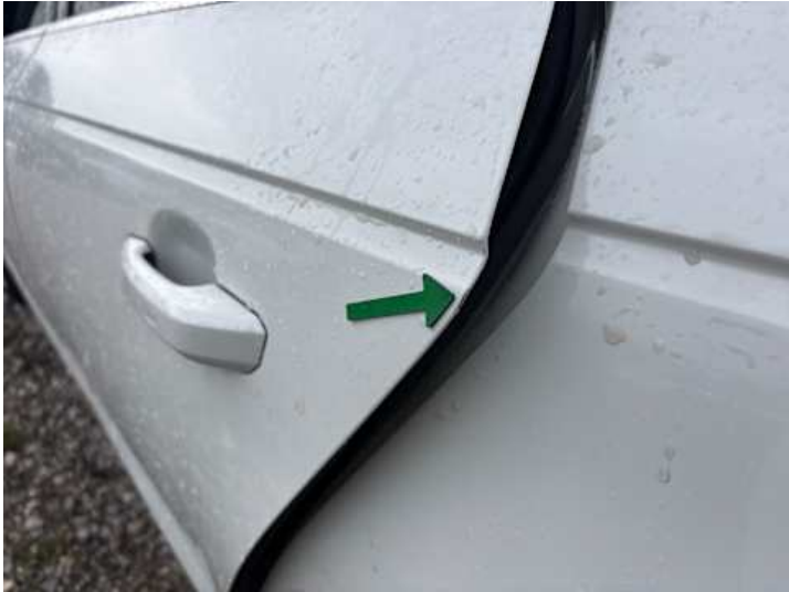
Türe hinten links (Lackschaden)
