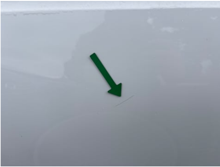
Türe hinten rechts (Kratzer, Lackschaden)
