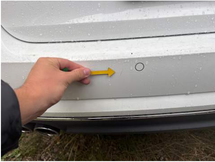
Stoßstange hinten (Kratzer, Lackschaden)
