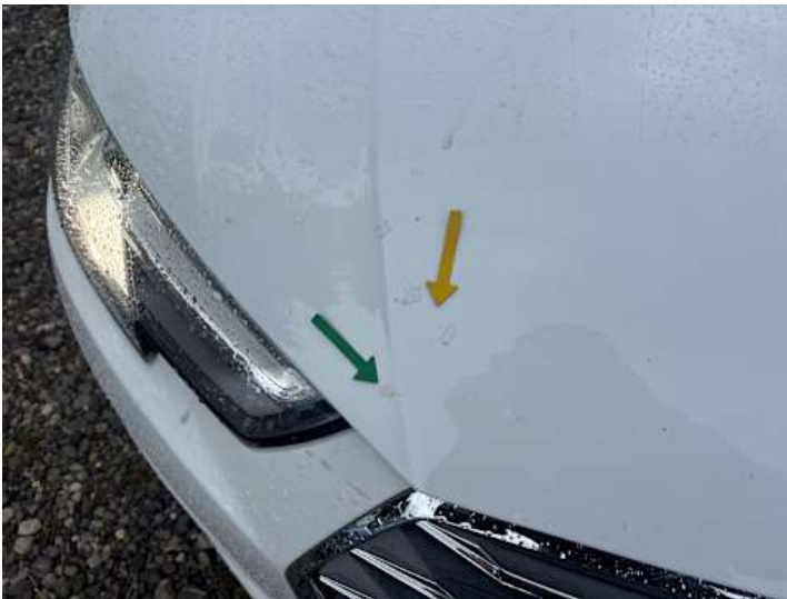
Motorhaube (Lackschaden, Rost, Steinschlag)
