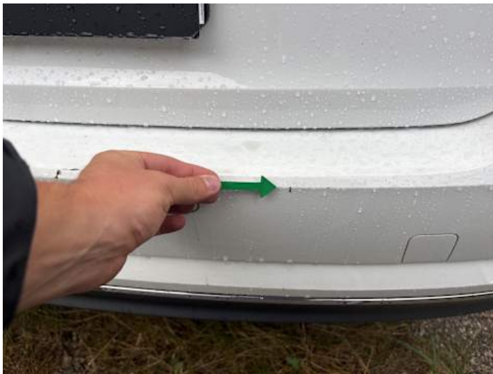
Stoßstange hinten (Kratzer, Lackschaden)
