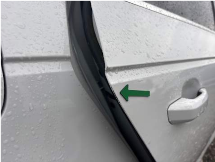
Türe hinten rechts (Kratzer, Lackschaden)
