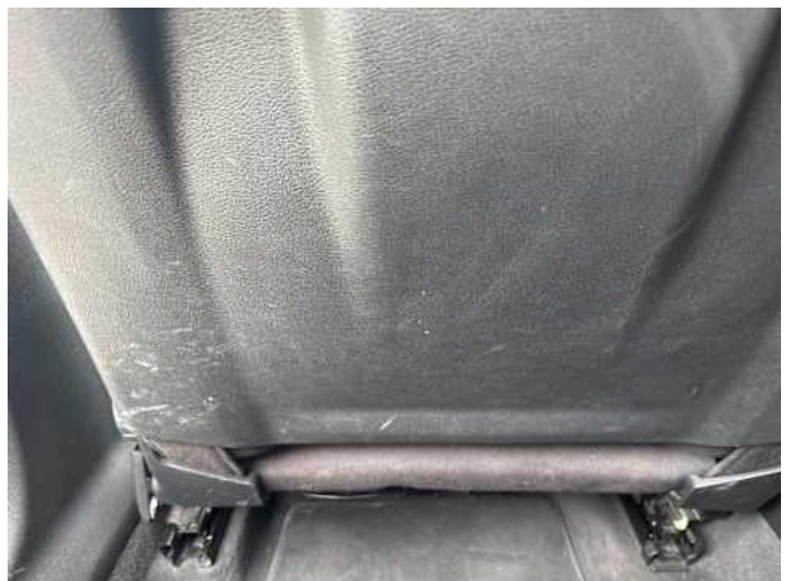
Innenraum (Verschmutzung, Kratzer)
