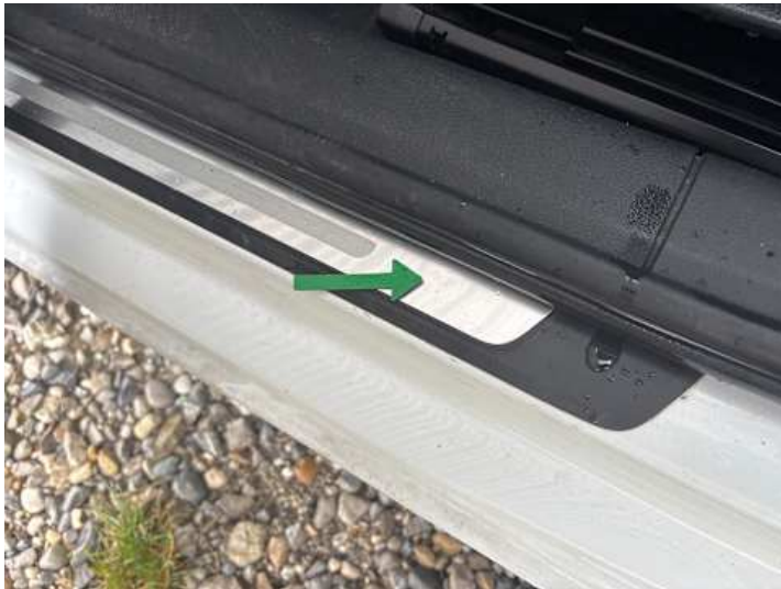
Schweller links (Lackschaden, Delle)
