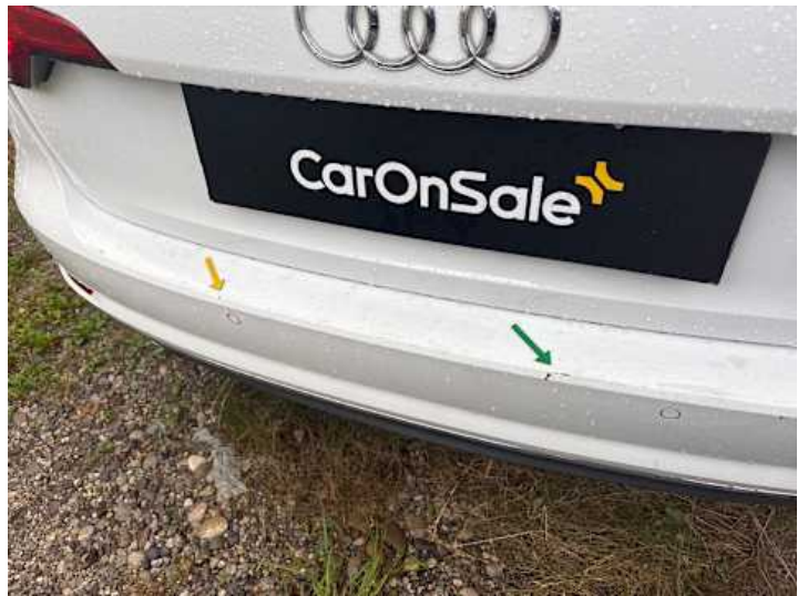
Stoßstange hinten (Kratzer, Lackschaden)
