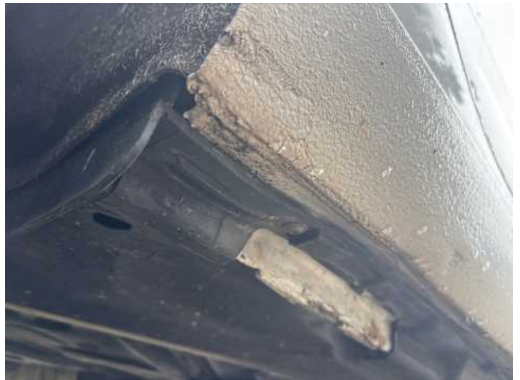
Schweller rechts (Lackschaden, Riss/Bruch)
