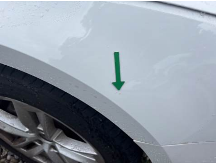
Kotflügel vorne rechts (Lackschaden, Unsachgemäß instand gesetzt)
