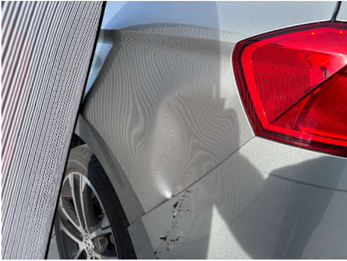
Seitenteil hinten links (Verformung)
