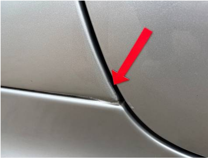
Seitenteil hinten rechts (Unsachgemäß instand gesetzt, Rost, Lackschaden)
