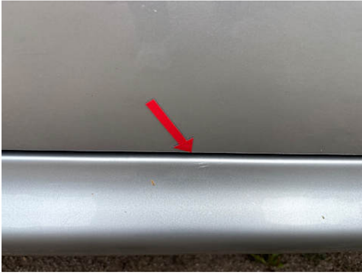
Schweller rechts (Kratzer)
