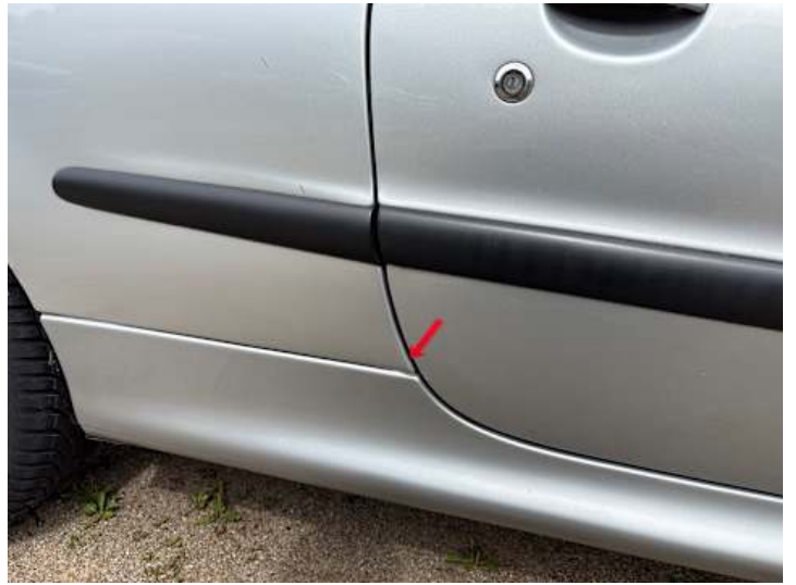
Seitenteil hinten rechts (Unsachgemäß instand gesetzt, Rost, Lackschaden)
